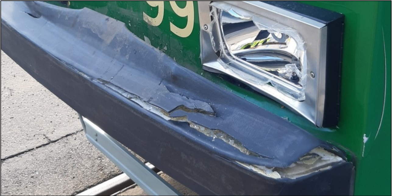
Bild 3. Skador på frampartiet på vagn 99 orsakade av kollisionen 31.3.2022. (Bild: Huvudstadsregionens Stadstrafik Ab)
