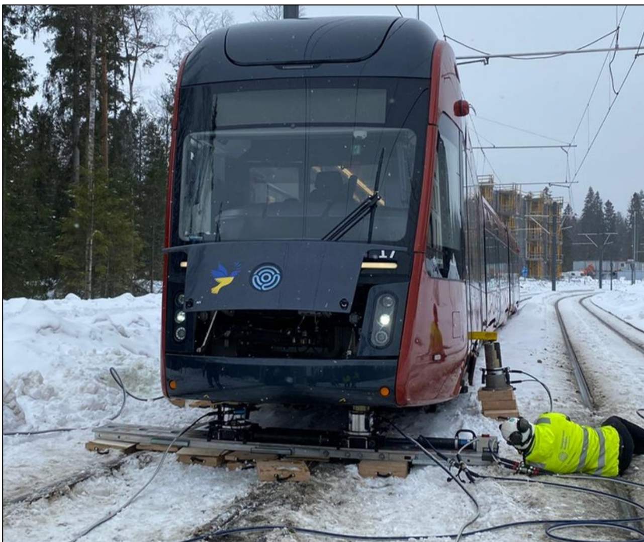
Bild 7. Spårvagnen som spårade ur vid Hervantajärvi 8.3.2022 lyfts upp på rälsen. (Bild: Tampereen Ratikka)
