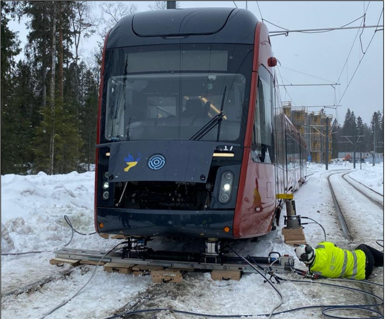
Kuva 7. Hervantajärvellä 8.3.2022 suistuneen raitiovaunun nosto kiskoille. (Kuva: Tampereen Ratikka)
