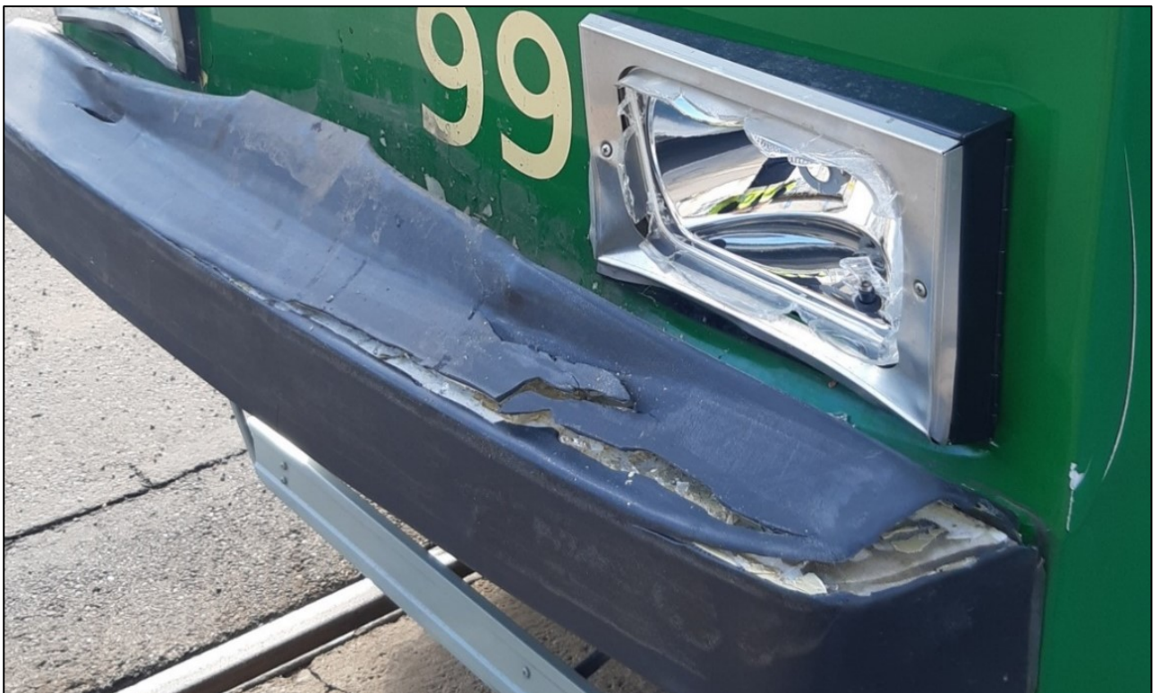
Kuva 3. Vaunun 99 keulaan 31.3.2022 törmäyksessä tulleet vauriot. (Kuva: Pääkaupunkiseudun Kaupunkiliikenne Oy)
