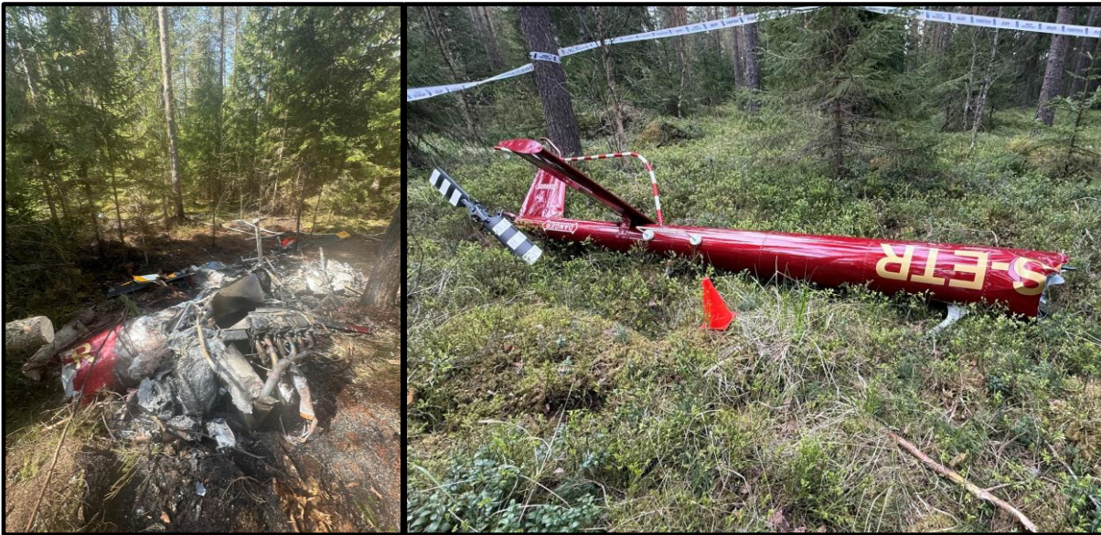
Kuva 2. Vasemmalla ES-ETR runko ja osa pääroottorista. Oikealla irronnut pyrstöpuomi. Viranomaiset ovat käyttäneet kartioita osien merkitsemiseen. (Kuva: OTKES)
