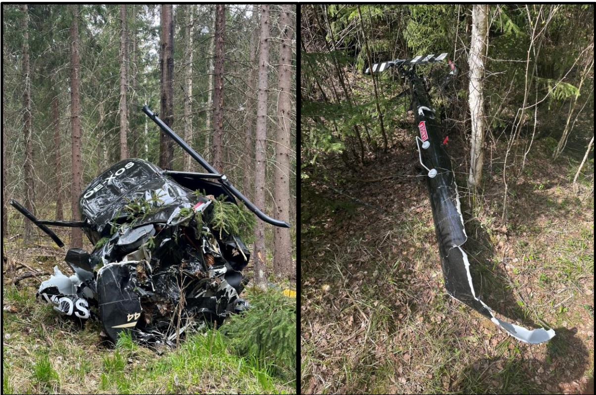
Kuva 3. OE-XOS runko vasemmalla ja pyrstöpuomi oikealla. (Kuva: OTKES)
