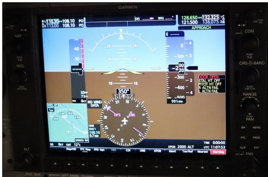
Kuva 5. Ovivaroituksen visuaalista näkymistä monitoiminäytöllä (PFD) havainnollistava kuva. Varoitusten ja huomioiden aktivoituessa ne näkyvät näytön oikeaan reunaan muodostuvassa ilmoitusikkunassa. Punaisen Warning-varoituksen aktivoituessa Warning-teksti vilkkuu punaisella taustalla näytön oikeassa alareunassa ja samalla kuuluu äänivaroitus. (Kuva: OTKES)
