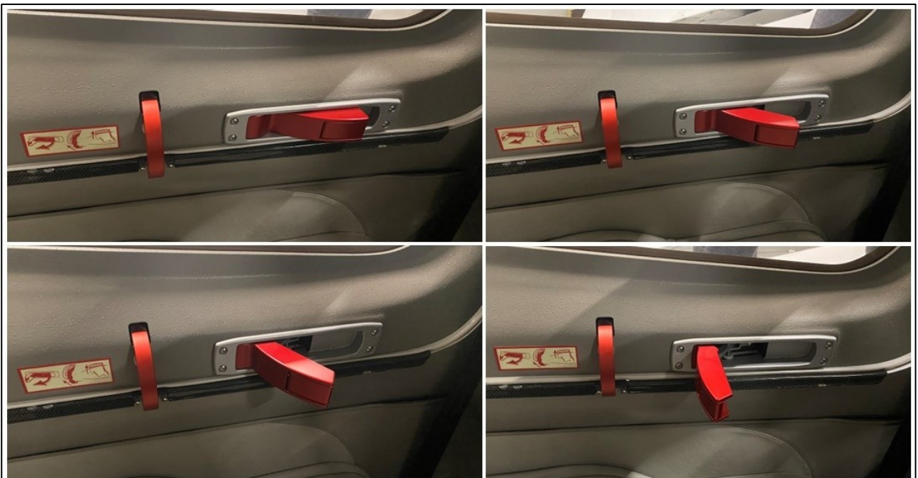
Kuva 10. Kuvasarja sisäpuolen kahvan asennoista. Ylhäällä vasemmalla kahva täysin lukitussa asennossa. Ylhäällä oikealla kahva auenneena noin 30 asteen kulmaan, jolloin ovivaroitus aktivoituu. Alhaalla vasemmalla kahva auenneena noin 50 asteen kulmaan, jolloin lukitustapit ovat pois lukituslevyn rei'istä, ja ovi pääsee aukeamaan turvahaan varaan. Oikealla alhaalla täysin auki asennossa oleva kahva. (Kuvat: Otkes)
