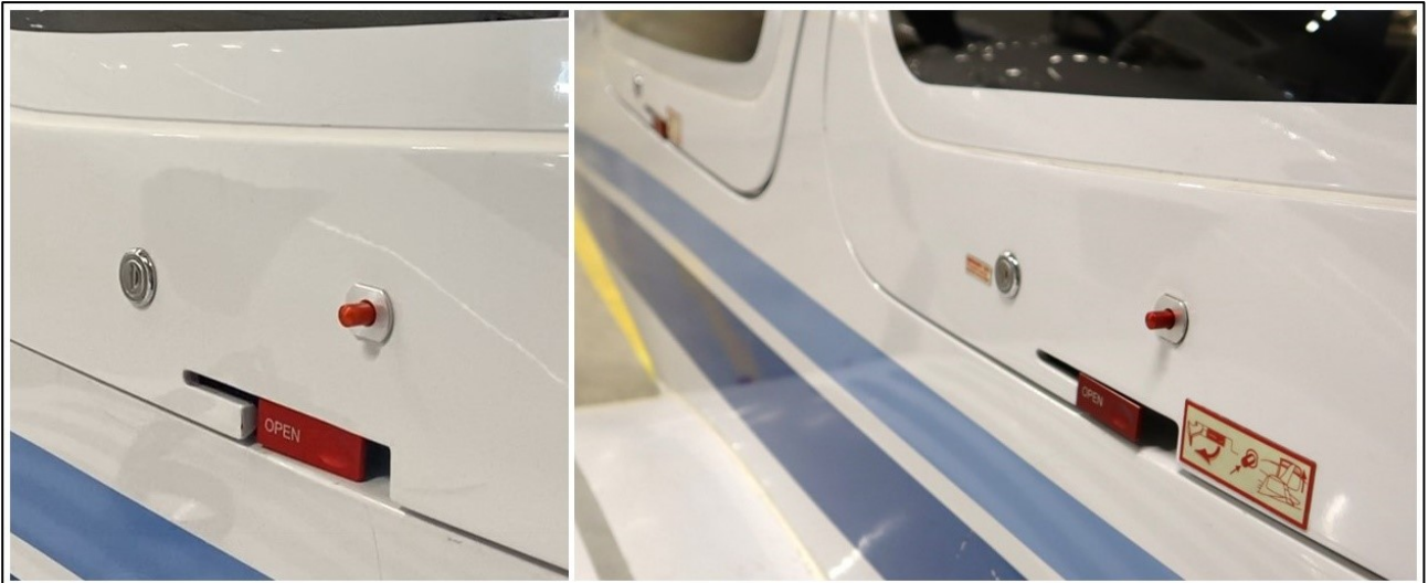
Kuva 12. Takaoven ollessa täysin kiinni ja lukittuna, ulkopuolen kahvan asento vaihteli lentokoneyksilöiden välillä. Vasemmassa kuvassa (OH-DAN, jossa uusi ovi) lukituskahva painuu oven pinnan tasosta sisäänpäin noin 8 millimetriä. Oikeassa kuvassa (OH-DAM) lukituskahva jää hieman koholle oven pinnasta. (Kuvat: Otkes)
