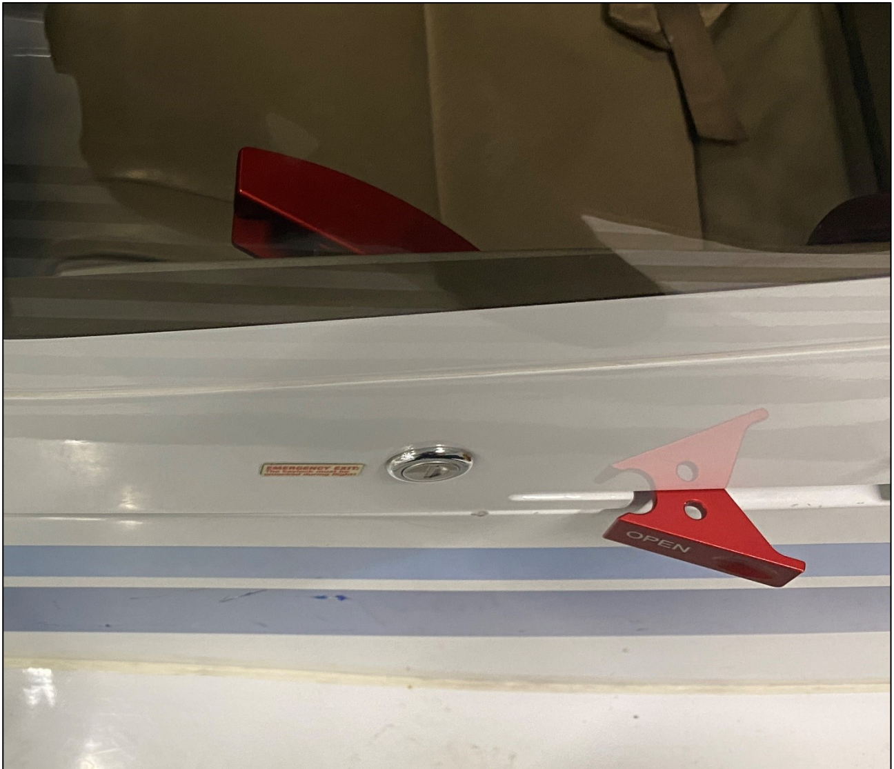
Kuva 11. Takaoven ulko- ja sisäkahvan asento avattuna kohtaan, jossa ovivaroitus aktivoituu (Kuva: Otkes)
