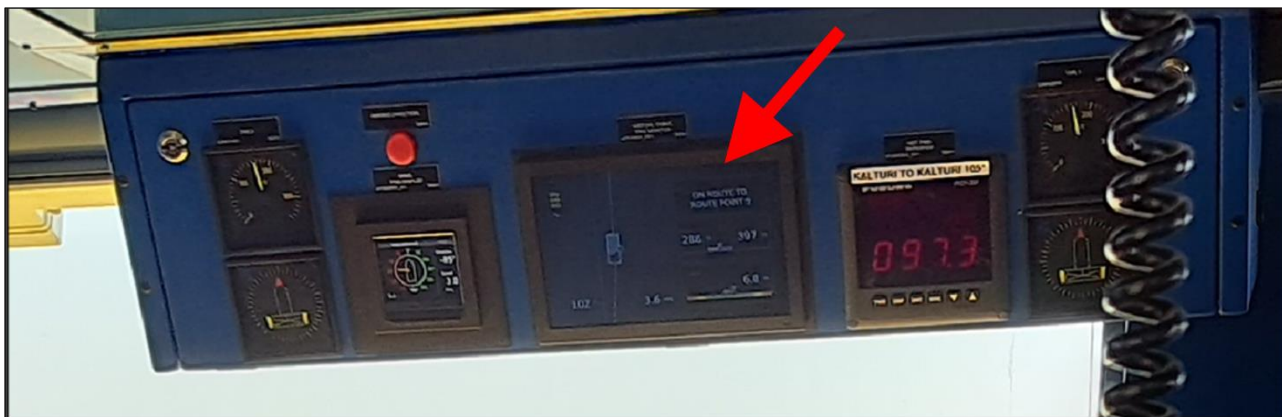
Bild 16. Skärmen för den virtuella vajern (pilen) i drift på vajerfärjan L-317. (Bild: OTKES)
