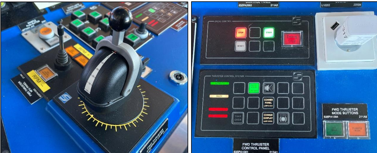
Bild 14. På den vänstra bilden manövreringsreglaget och reservstyrningsspaken för den konstruktionsmässigt främre propellern på vajerfärjan L-317. På den högra bilden styrpanelerna för den konstruktionsmässigt främre propellern. (Bilder: OTKES)
