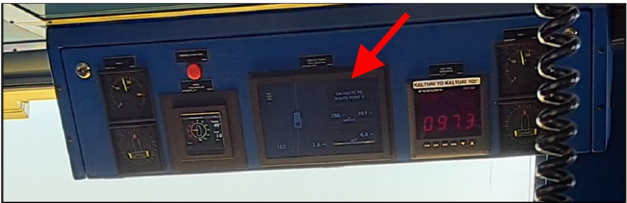
Kuva 16. Virtuaalivaijerin näyttö (nuoli) toiminnassa L-317-lossilla. (Kuva: OTKES)
