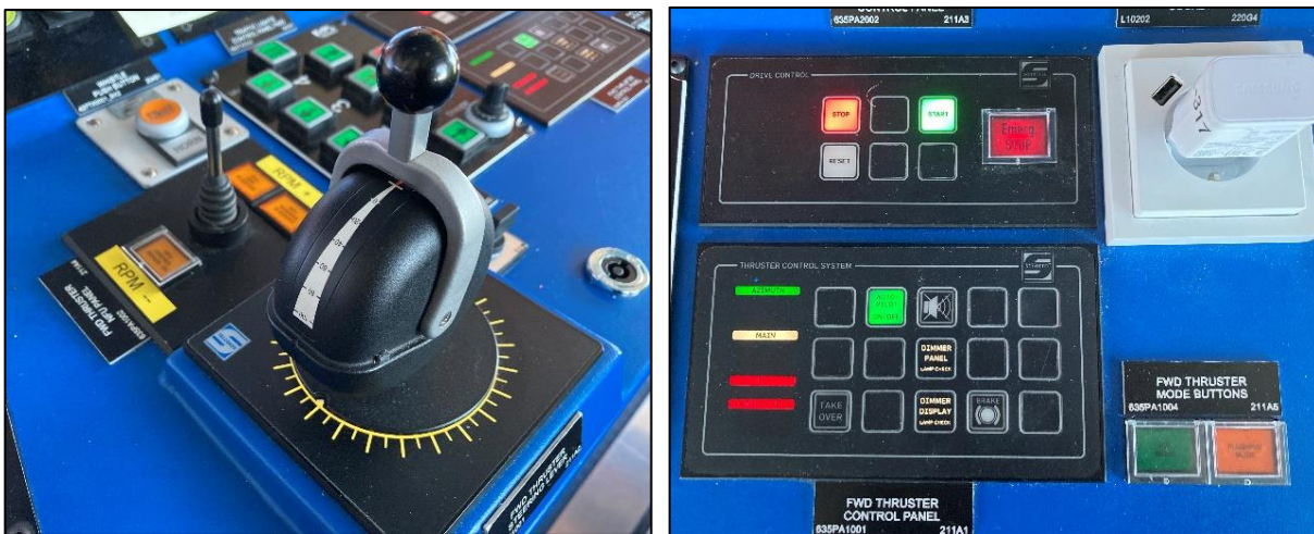
Kuva 14. Vasemmanpuoleisessa kuvassa lossi L-317:n rakenteellisen keulapotkurin ohjailukahva sekä varaohjausvipu. Oikeanpuoleisessa rakenteellisen keulapotkurin ohjauspaneelit. (Kuvat: OTKES)
