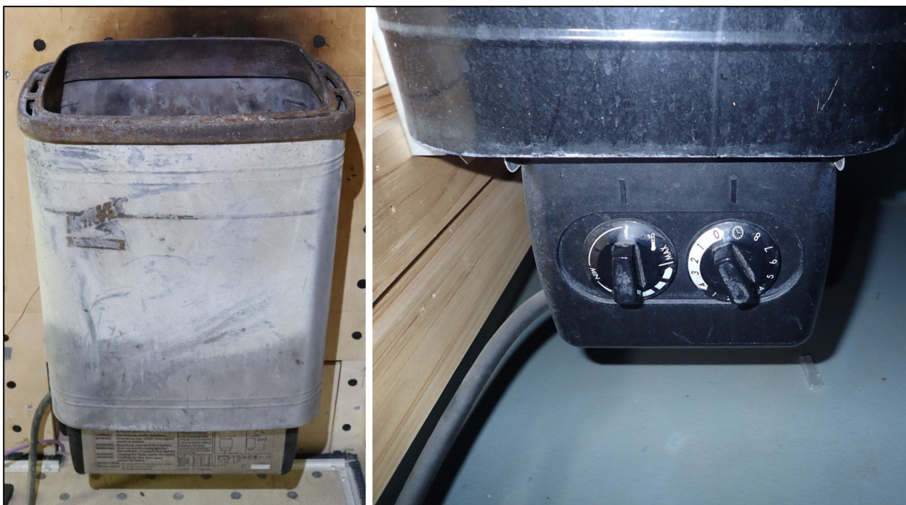
Kuva 6. Kuvassa vasemmalla on palanut kiuas uudelleen sähköistettynä ja oikealla saman ikäisen kiukaan ohjainlaitteet. Oikeanpuoleisen kuvan kiuas on saman kerrostalon toisen huoneiston saunassa. (Kuva: OTKES)
