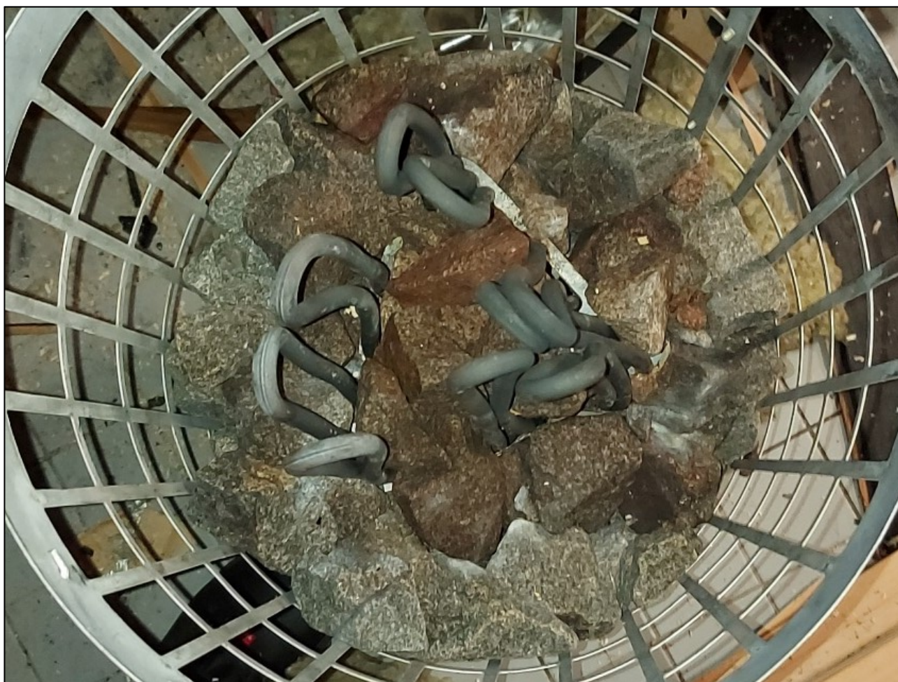
Kuva 21. Kanta-Hämeen tulipalossa olleen kiukaan kiviä poistettaessa havaittiin kivien olevan merkittävän tiiviisti. Kiukaan vastukset olivat vääntyneet siten, että osa niistä kosketti toisiaan. Kiukaan keskellä olleisiin kiviin oli tullut värimuutoksia. (Kuva: Kanta-Hämeen pelastuslaitos)
