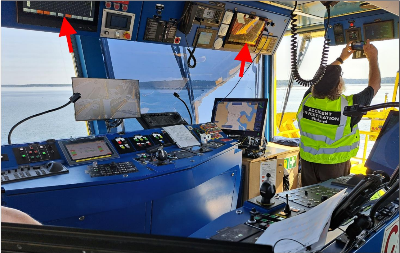
Kuva 7. Laiva-automaation (IAS) näyttöjen sijainti nuolten osoittamana. (Kuva: OTKES)
