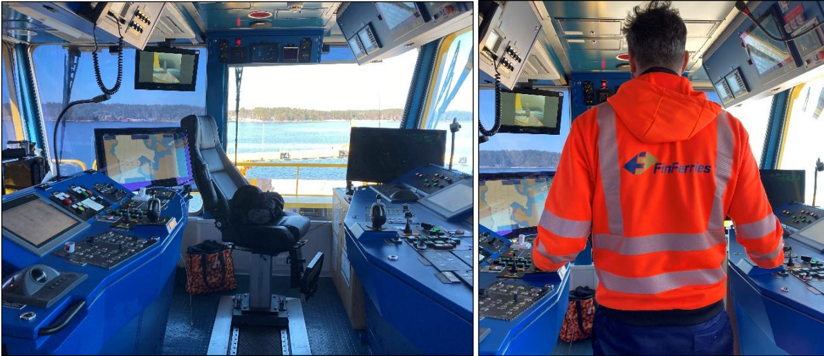
Kuva 13. Vasemmassa kuvassa näkymä lossin L-317 ohjaamosta, ohjailupaikalta keulaan päin. Kuvassa näkyvät ohjailukahvat konsolien reunassa, ohjailupaikan molemmilla puolilla. Oikeanpuoleisessa kuvassa näkyy, miten lossia ohjailaan molempia ohjailukahvoja yhtä aikaa käyttäen. (Kuvat: OTKES)
