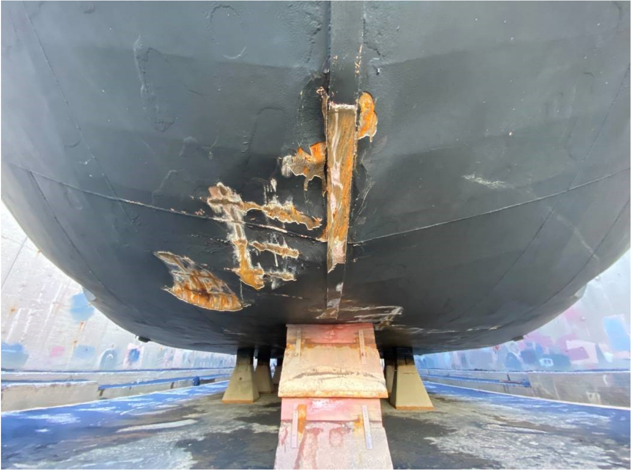
Kuva 9. Pohjan vaurioita. (Kuva: Merivoimat)
