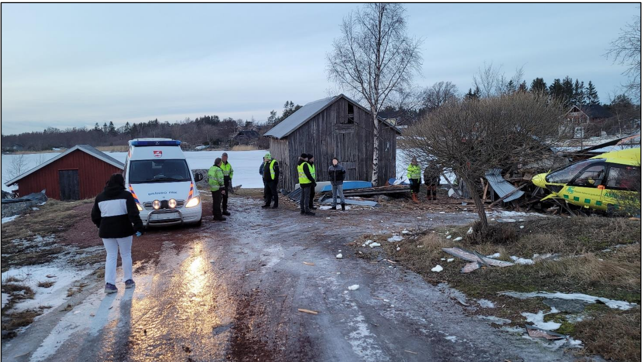
Kuva 8. Suunniteltu laskupaikka vaalean ajoneuvon kohdalla, oikealla helikopterin pysähtymispaikka liukumisen jälkeen. Paikka kuvattuna noin 30 minuuttia tapahtuman jälkeen. Kopteri on kuvassa lähes laskeutumissuunnassa. (Kuva: Babcock Scandinavian)
