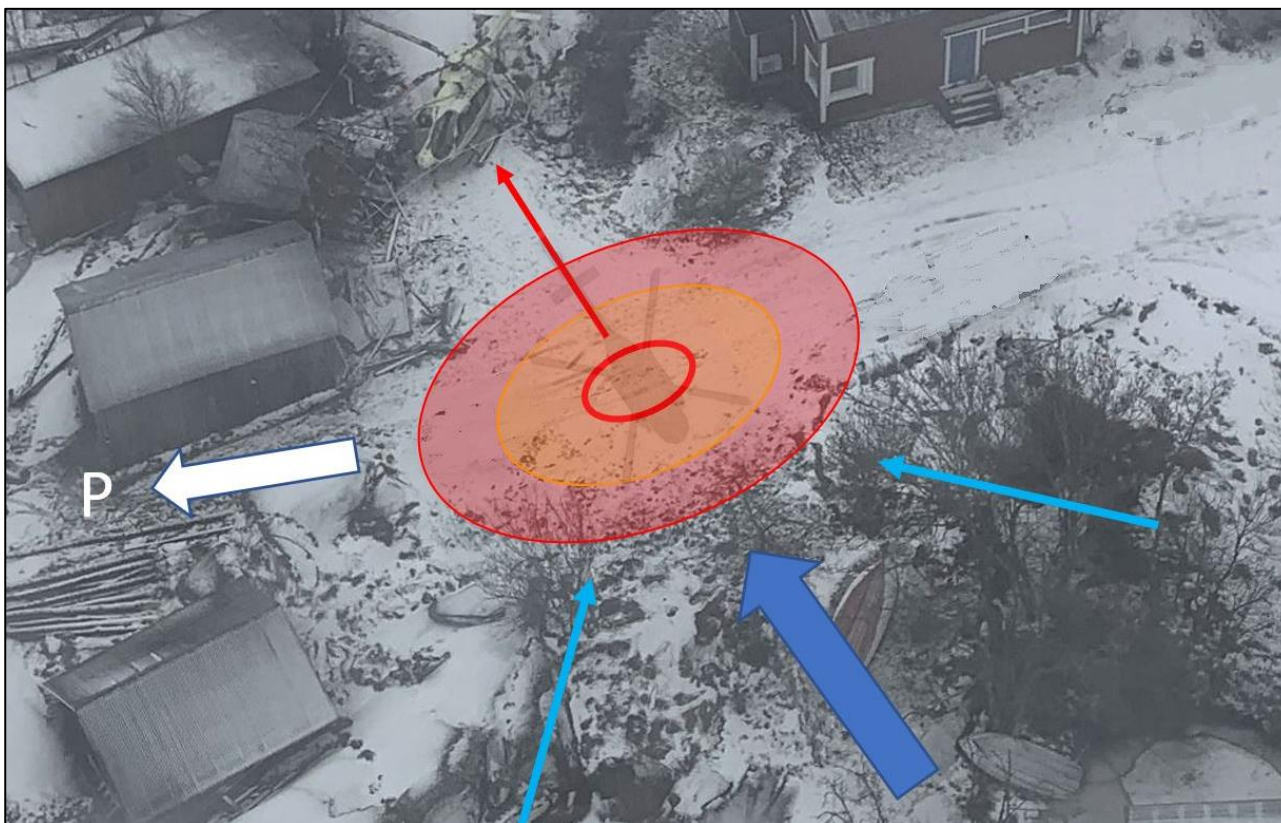
Bild 3. Uppskattad landningsplats och säkerhetszoner markerade. Det gulmarkerade området är en 11 meters säkerhetszon för huvudrotorns blad. Det större rödmarkerade området är hela säkerhetszonen på 17 meter. Den röda pilen anger helikopterns glidriktning. De blå pilarna beskriver vindens huvudriktning och variationsvidd. Den vita pilen anger kartnorr. (Bild: OTKES, foto från 13.2)
