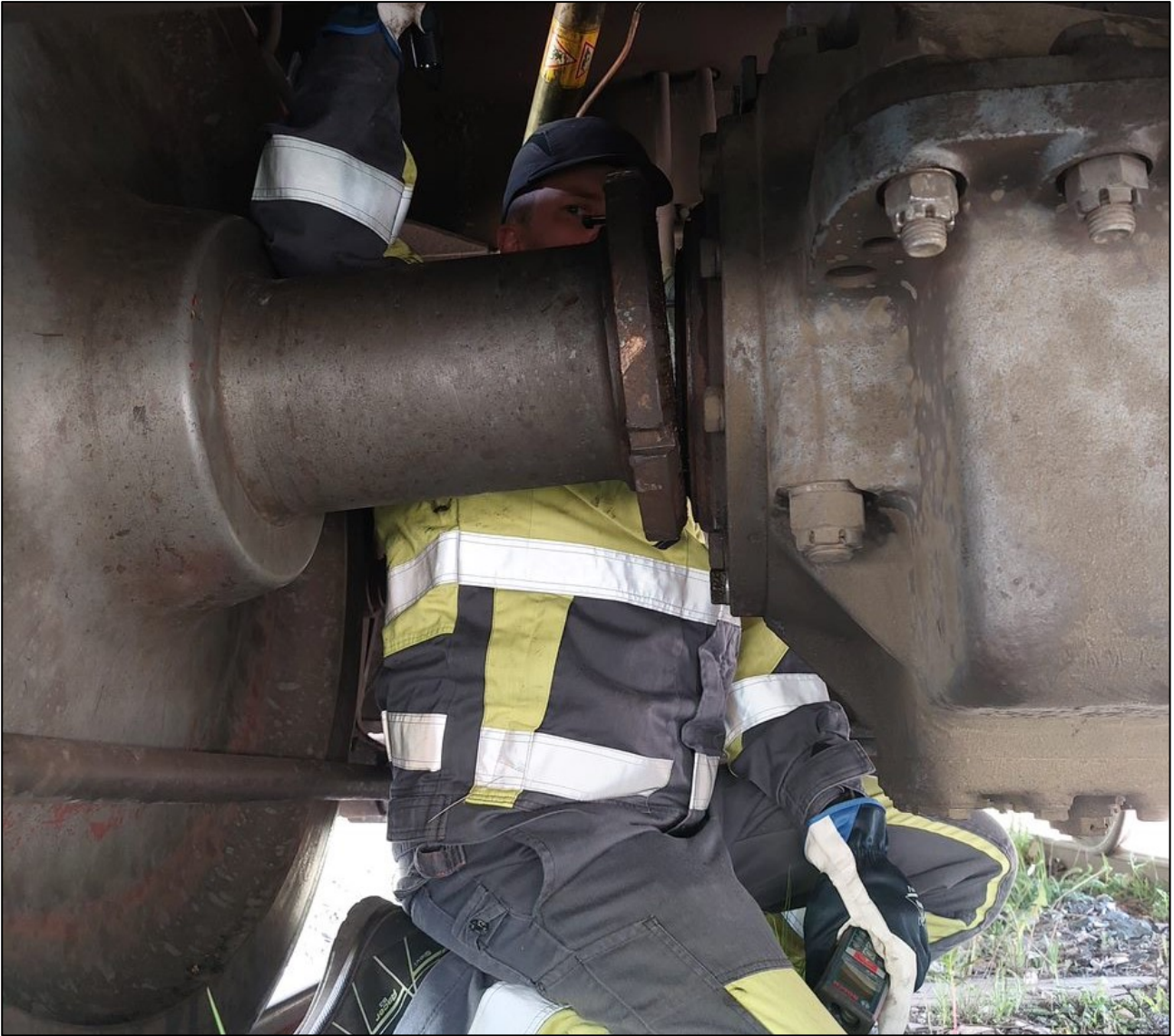
Bild 2. Axeln brast mellan axelns drivanordning och axelmuttern. (Bild: VR-Group Ab)
