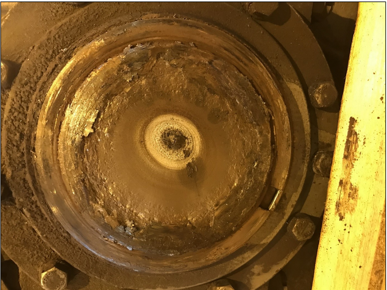
Bild 3. Punkten där axeln brast fotograferad i axelns riktning. (Bild: OTKES)
