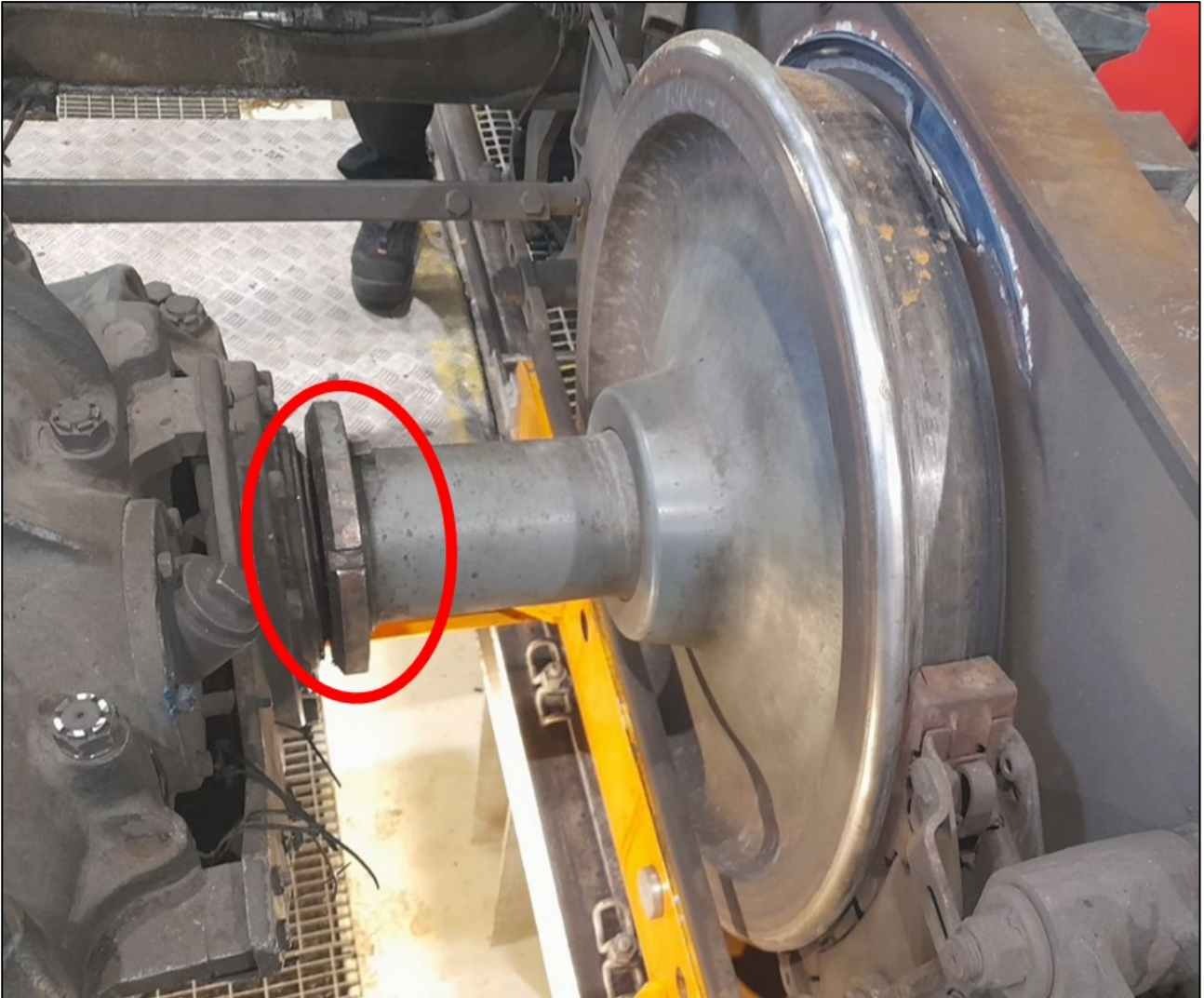
Bild 4. Axelmuttern har markerats med en röd cirkel. (Bild: VR-Group Ab, anteckningar: OTKES)
