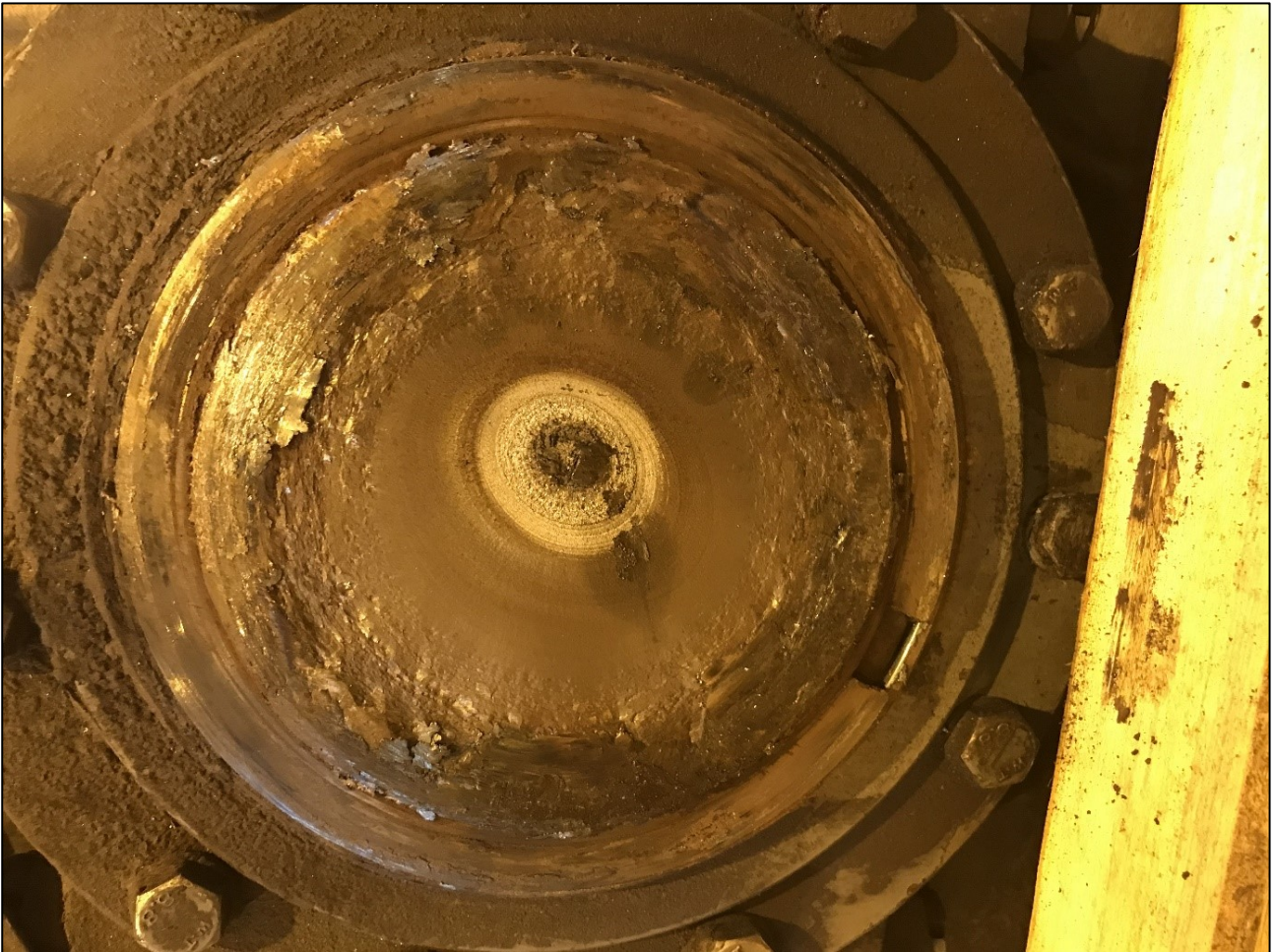
Kuva 3. Katkeamiskohta akselin suuntaisesti kuvattuna. (Kuva: OTKES)
