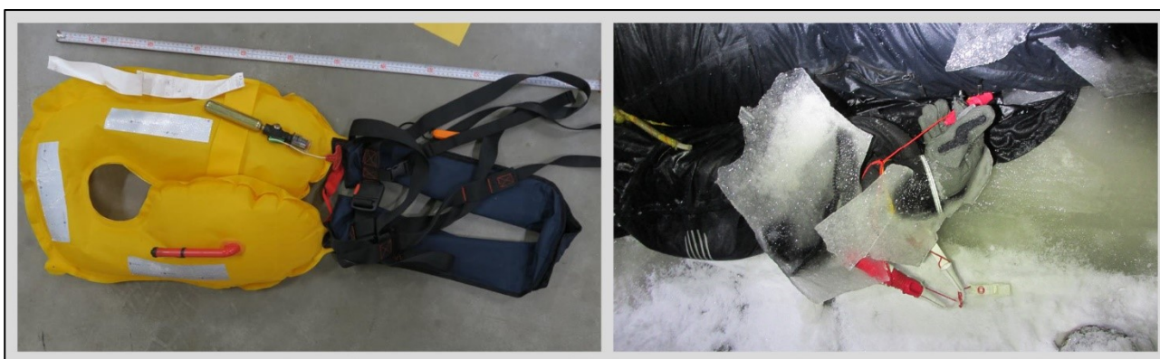
Kuva 29. Pelastautumisvälineiden kuvia. Vasemmalla paukkuliivit, jonka pakkaamisessa tai pukemisessa oli ollut puutteita, eikä liivi toiminut suunnitellusti. Oikeassa kuvassa esimerkki jäihin pudonneen yrityksistä käyttää jäänaskaleita. (Kuvat: poliisi)
