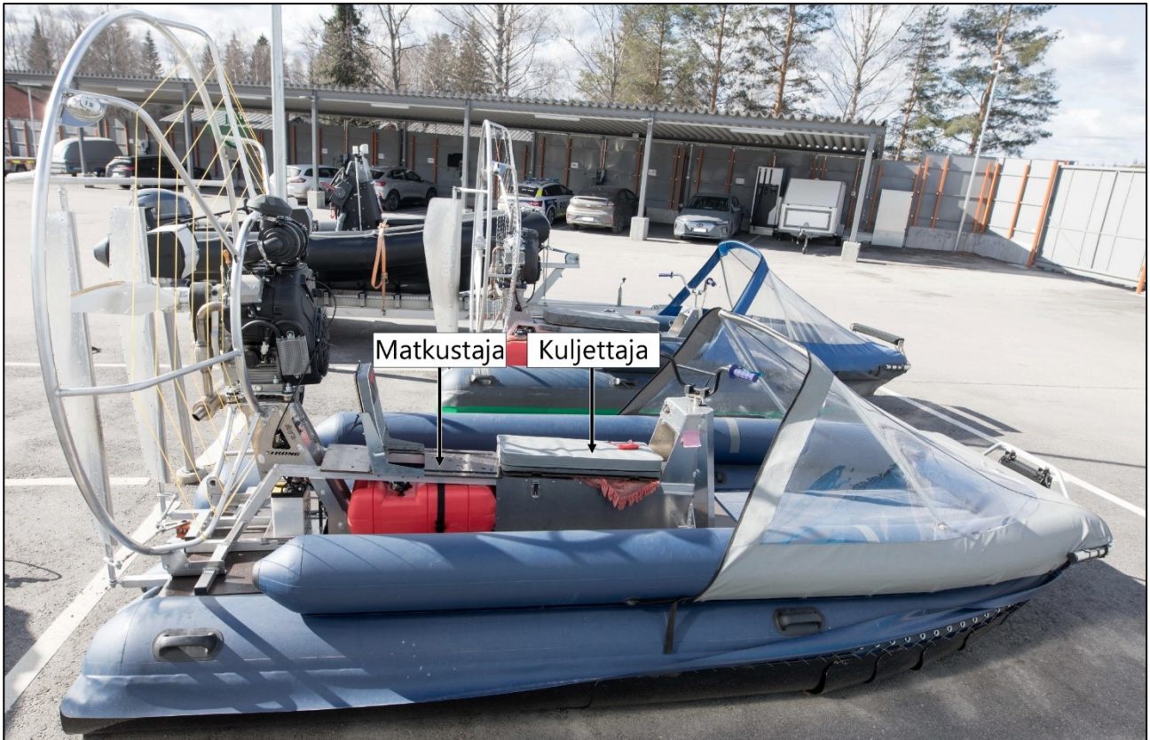
Kuva 2. Onnettomuuteen joutunut hydrokopteri kuvassa etualalla. Kuljettaja istui ohjaustangon takana ja matkustaja hänen takanaan. Roottorin suojaus on toteutettu naruilla. (Kuva: OTKES)
