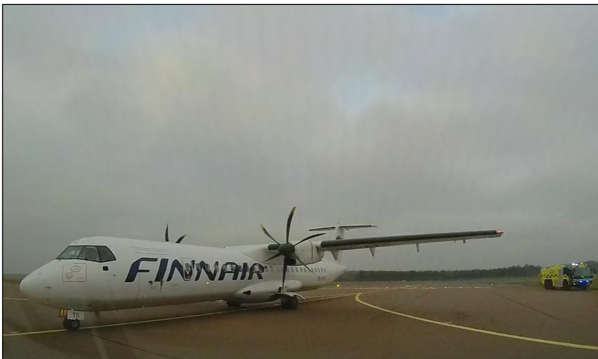
Bild 1. OH-ATG på taxibana Y på väg att taxa mot parkeringsplats 8. På bilden syns den öppna kommunikationsluckan under det bakre fönstret samt det utdragna öppningshandtaget på lastrummets dörr och den öppna tryckutjämningsluckan bredvid handtaget som öppnas samtidigt som handtaget dras ut. (Bild: Finavia Abp).
