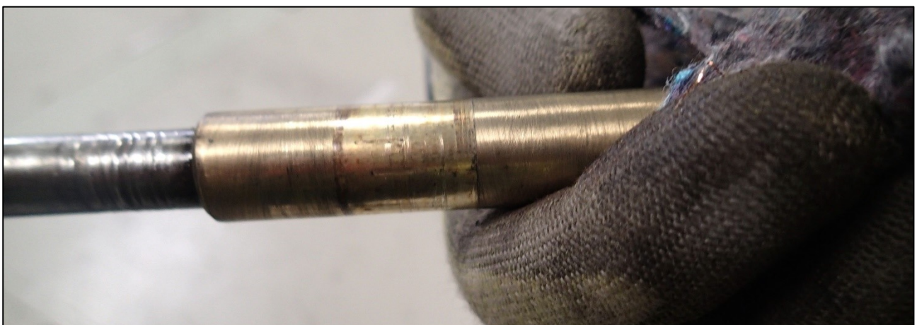
Bild 5. Närbild av kolvens glidyta i bromsens lossningscylinder. På ytan syns spår av förslitning och kärvning. (Bild: OTKES)
