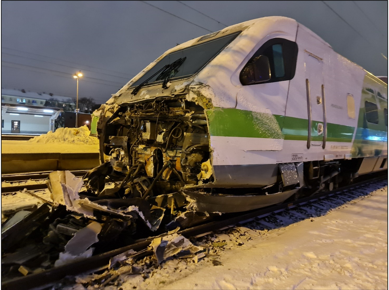
Kuva 2. Raiteen 006 pohjoispäässä seisseen Sm3-junayksikön 7013 keulan vauriot. (Kuva: Fintraffic Raide Oy)
