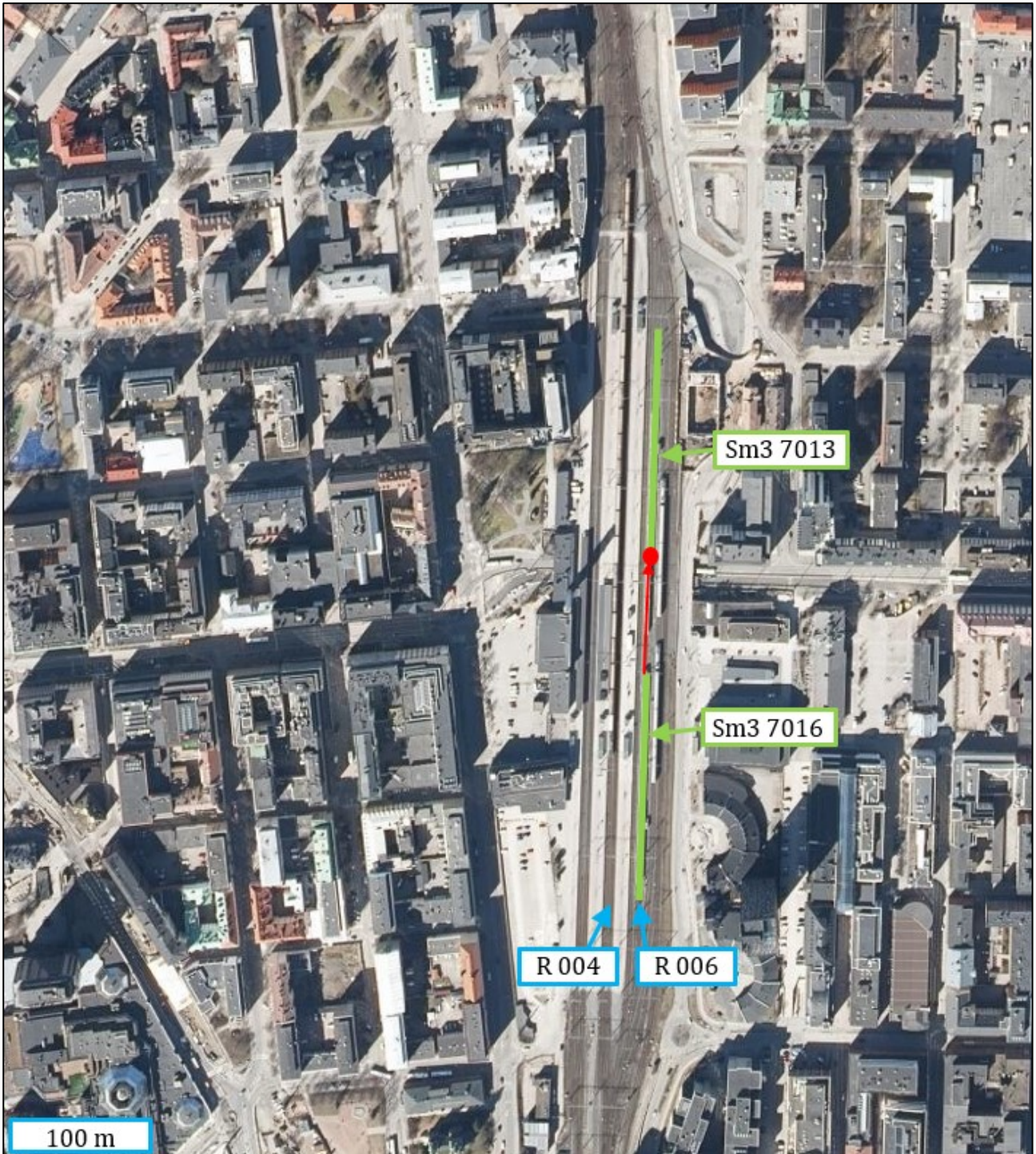
Kuva 1. Ilmakuva Tampereen aseman ratapihasta. Kuvaan on merkitty raide 006, ja sillä seissee Sm3-junayksiköt 7013 ja 7016 sekä raide 004 jonne toinen Sm3-junayksikkö oli tarkoitus siirtää pohjoisen (kuvassa ylhäällä) kautta. Työntöliike on esitetty punaisella nuolella ja törmäyspaikka punaisella pisteellä. (Ilmakuva ©Maanmittauslaitos 12/2021, Merkinnät: OTKES)
