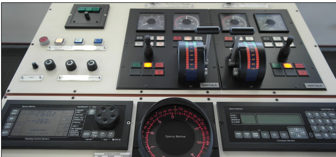
Bild 10. På bilden syns fartygets styrenheter och maskinkontrollenheter. (Bild: OTKES)
