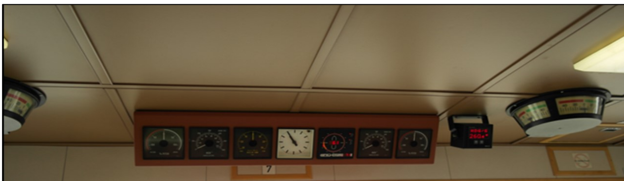
Bild 9. Skärmar i takkonsolerna, separat skärm för förriktning, panoramaskärmar för rodervinkel. (Bild: OTKES)
