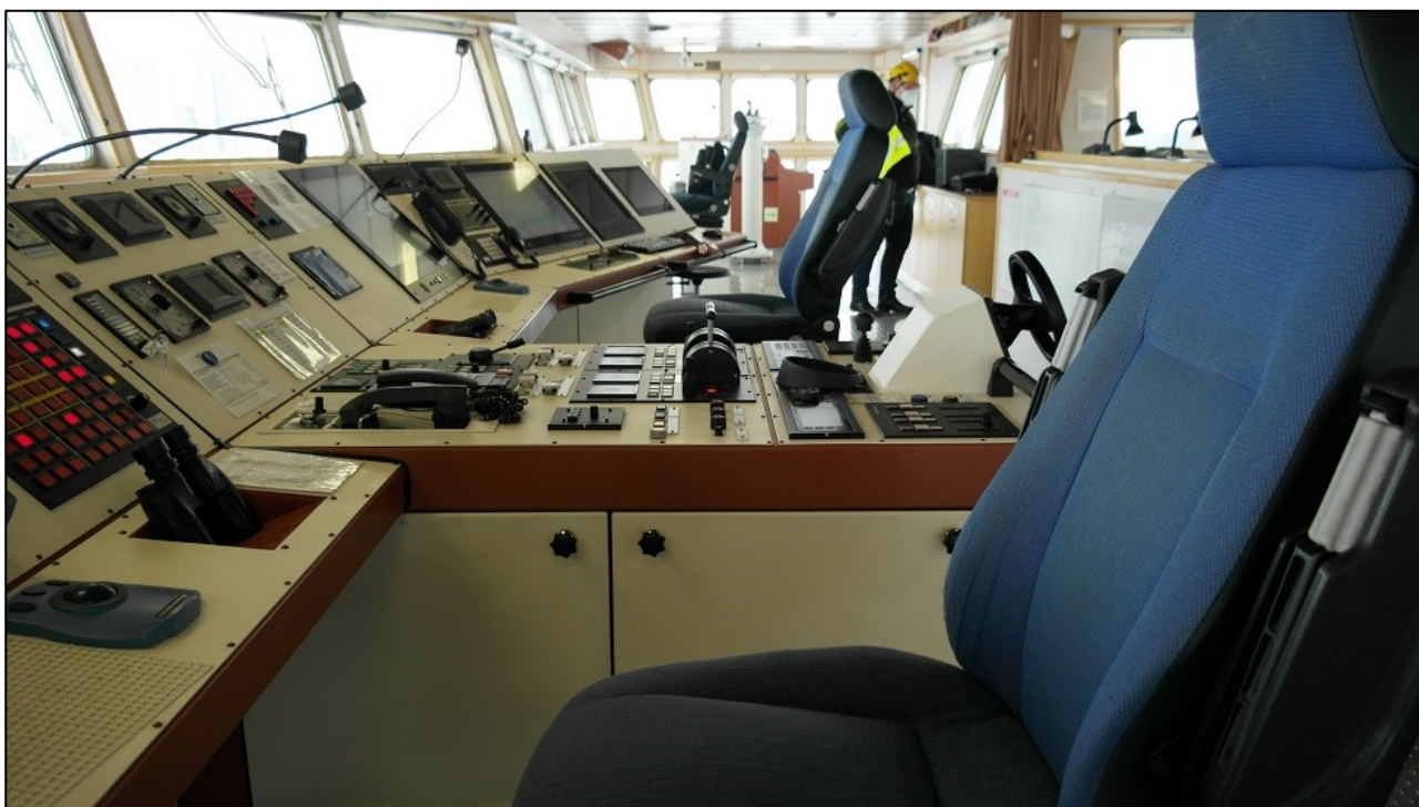
Bild 7. Arbetsstationer på kommandobryggan, i mittkonsolen ett roder för manuell styrning. (Bild: OTKES)
