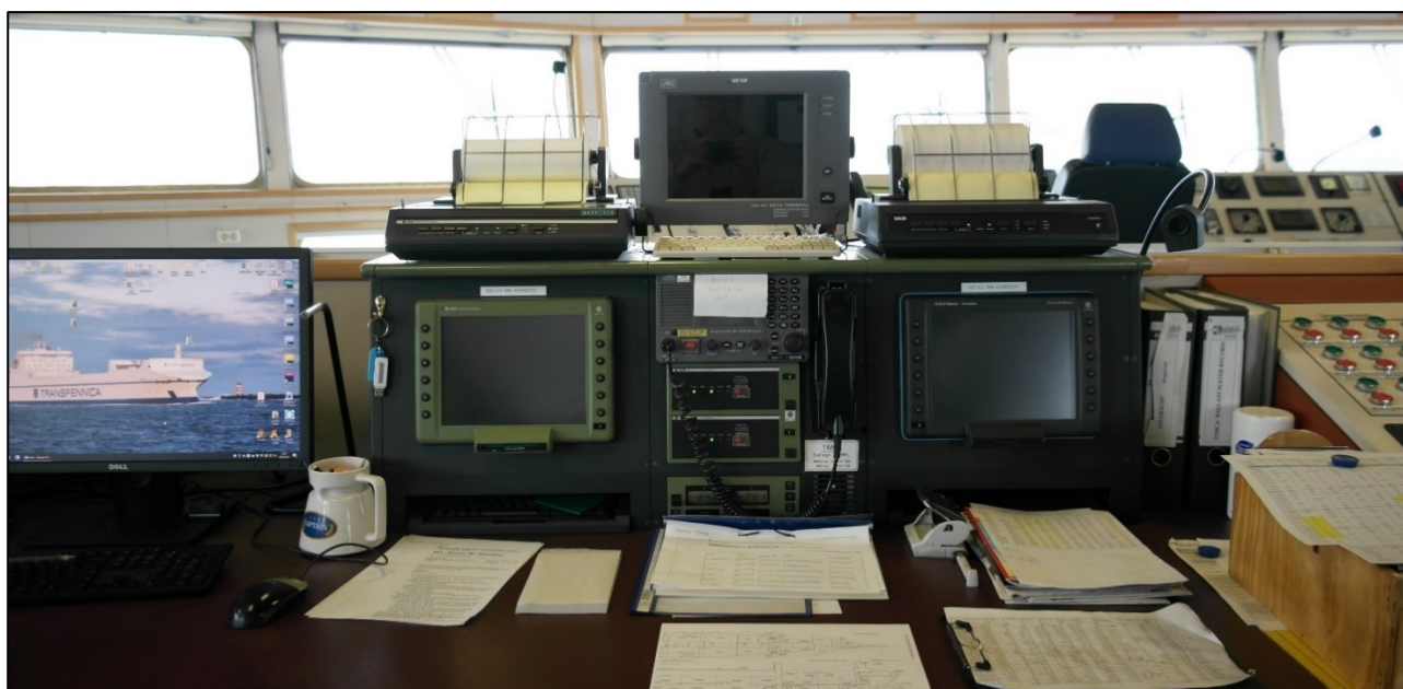
Bild 11. Fartygets GMDSS-radiostation. (Bild: OTKES)
