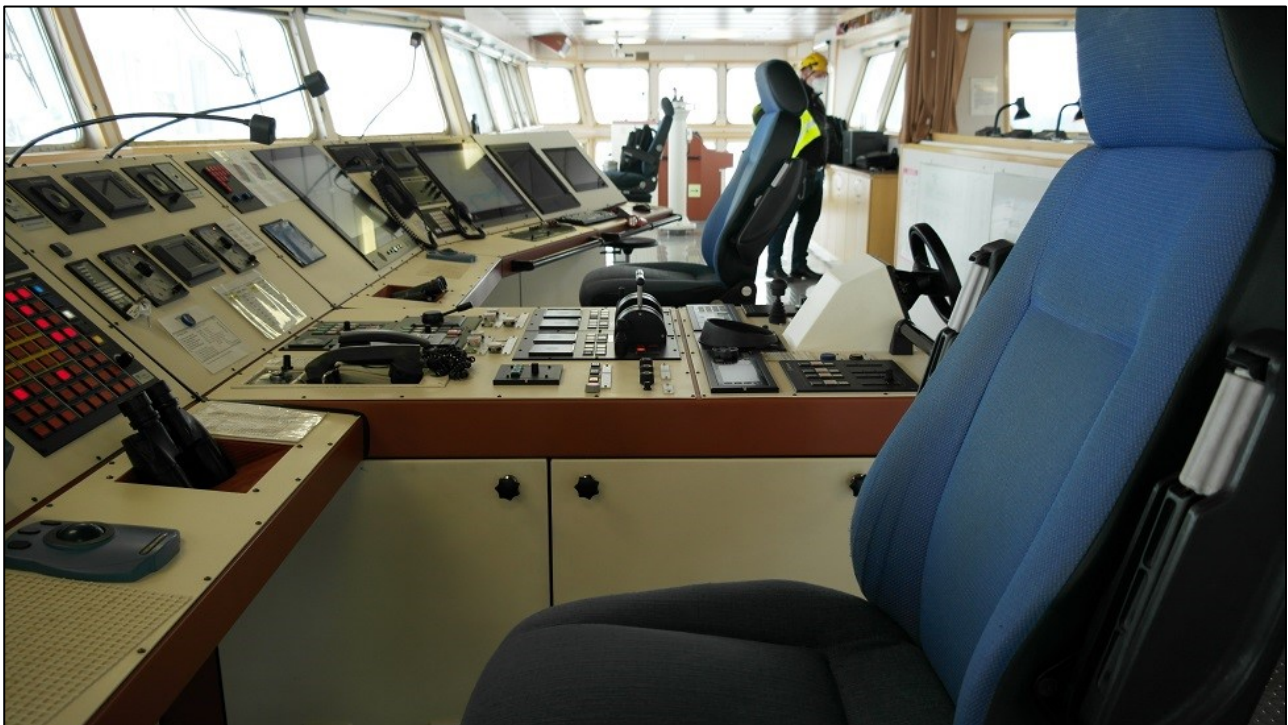
Kuva 7. Komentosillan työpisteet, keskikonsolissa ruori käsiohjausta varten. (Kuva OTKES)
