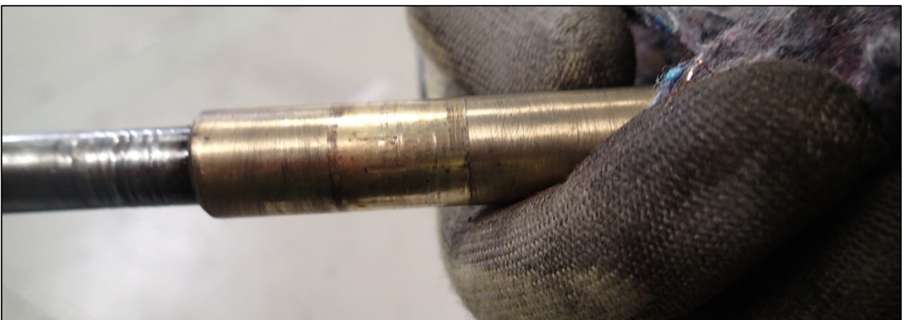
Kuva 5. Lähikuva irrotussylinterin männän liukupinnasta. Pinnassa on kulumis- ja kiinnileikkautumisjälkiä. (Kuva: OTKES)
