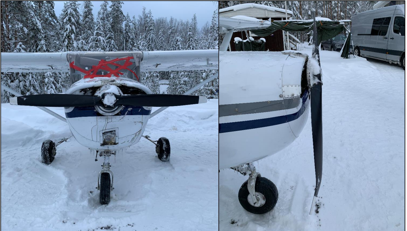
Kuva 3. Tuulilasi rikkoutui ja potkuri vaurioitui. Tuulilasi oli teipattu onnettomuuden jälkeen. (Kuvat: OTKES)
