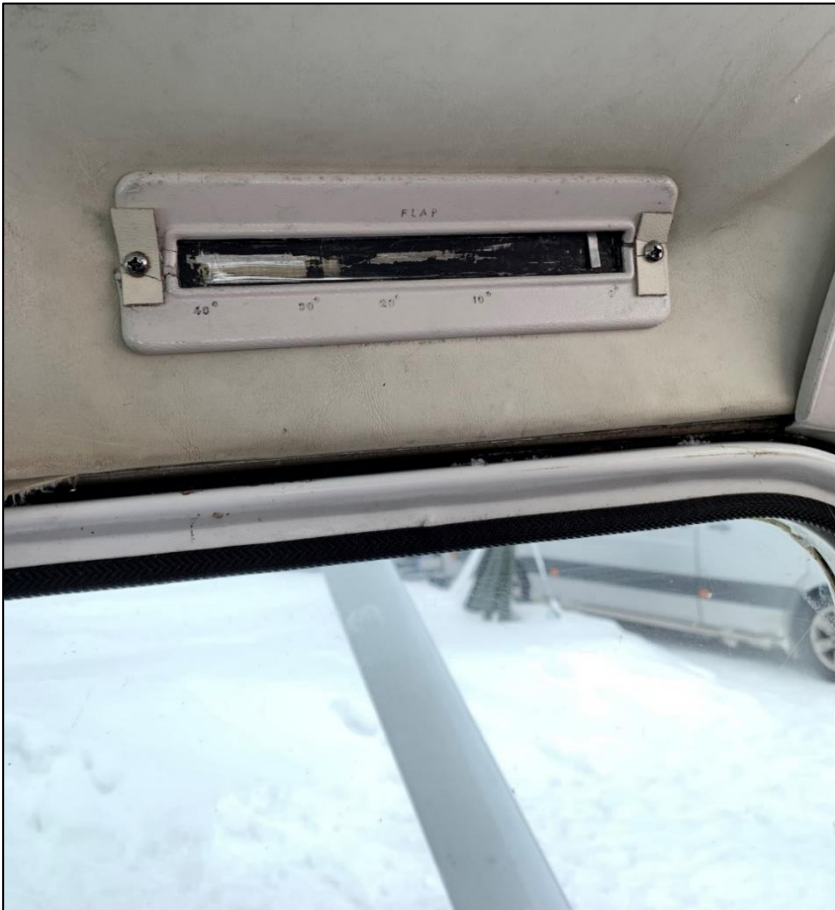
Kuva 8. Laskusiivekkeiden asennon osoitin vasemman oven yläpuolella. (Kuva: OTKES).
