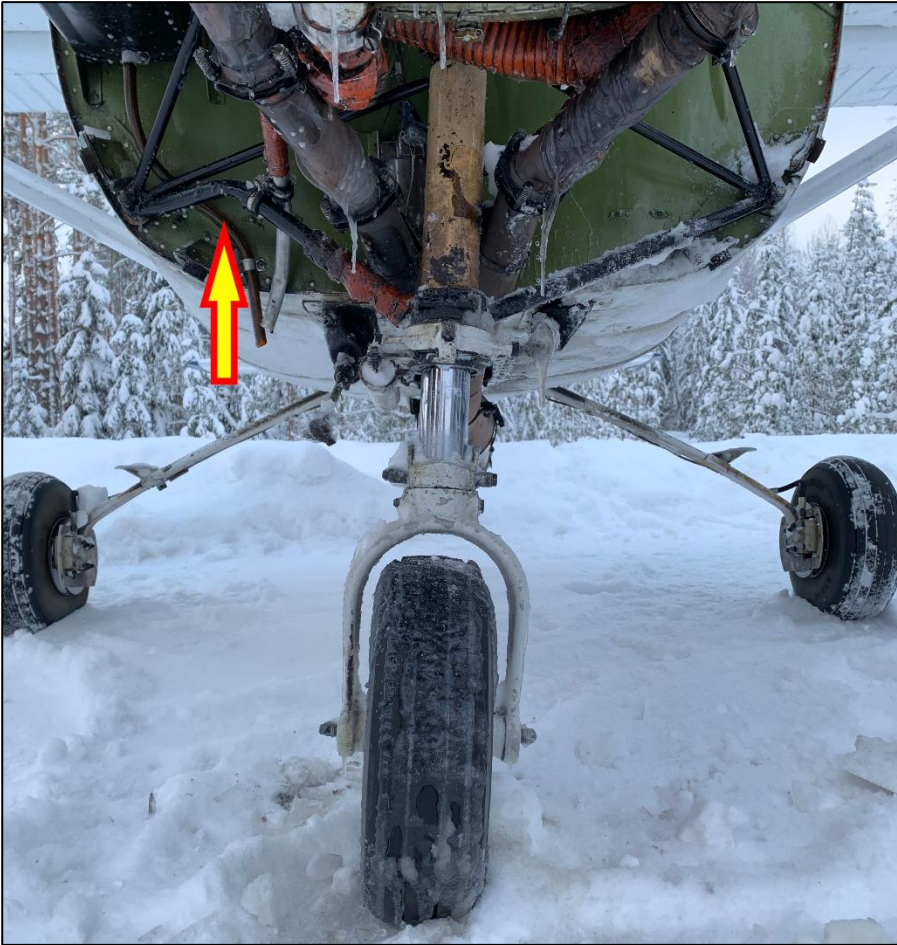
Kuva 5. Nokkateline ja nuolella merkitty moottoripukki vaurioituvat. (Kuva: OTKES)
