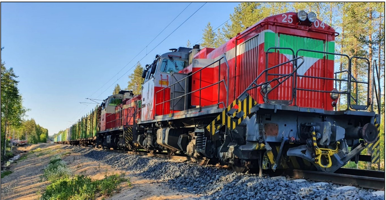
Kuva 1. Vaihtotyöyksikön ensimmäinen veturi suistui kiskoilta ja ajoneuvoyhdistelmän perävaunu paiskautui ojaan. (Kuva: Rataliikennekeskus)
