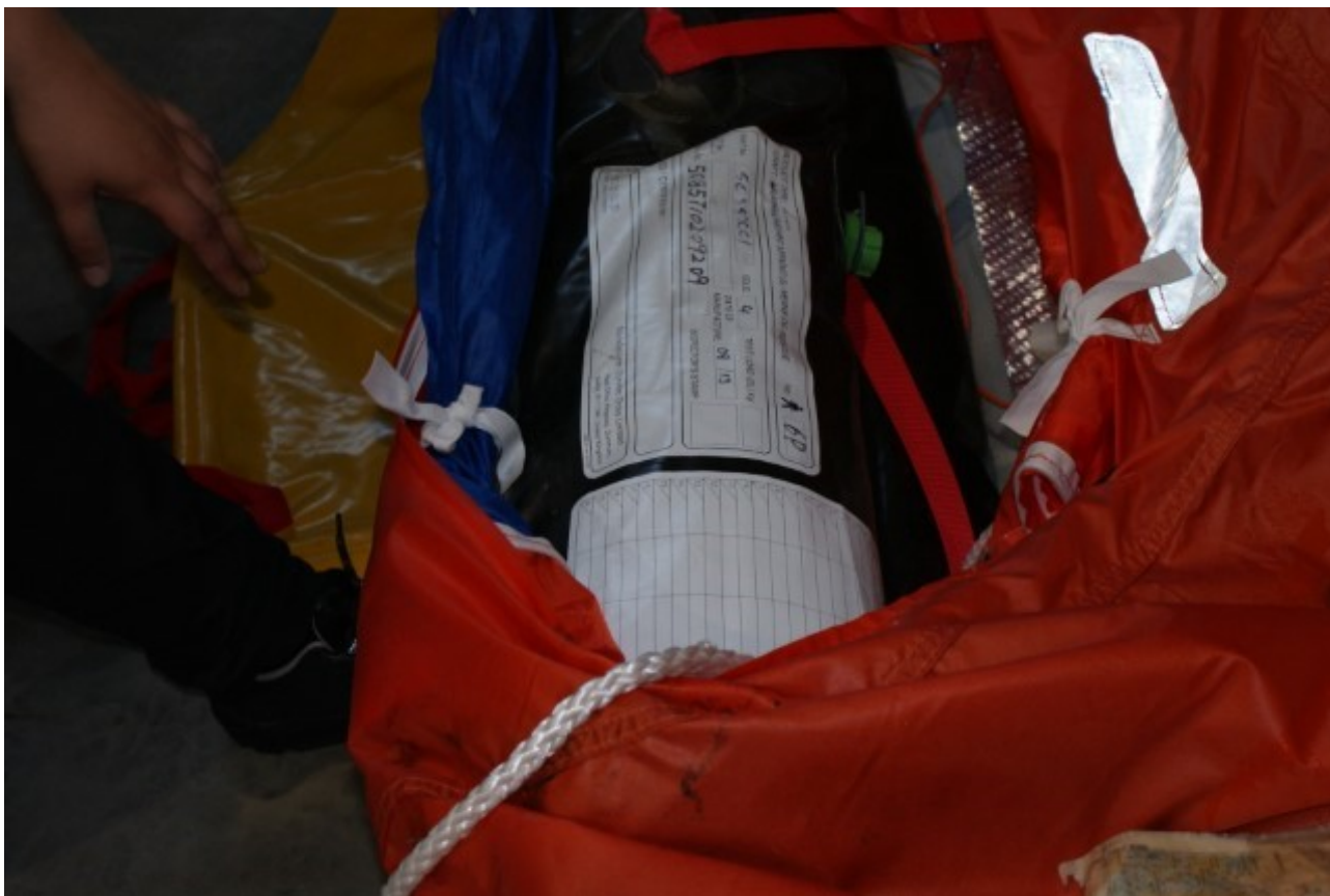
Bild 16. Räddningsflottens typskylt och serviceuppföljning. (Bild: Otkes)
