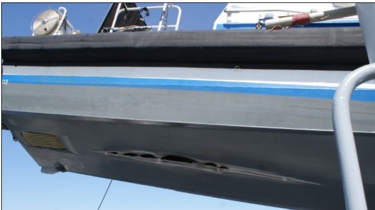
Bild 4. Skadan och hålet i PV 83:s botten. (Bild: Otkes)
