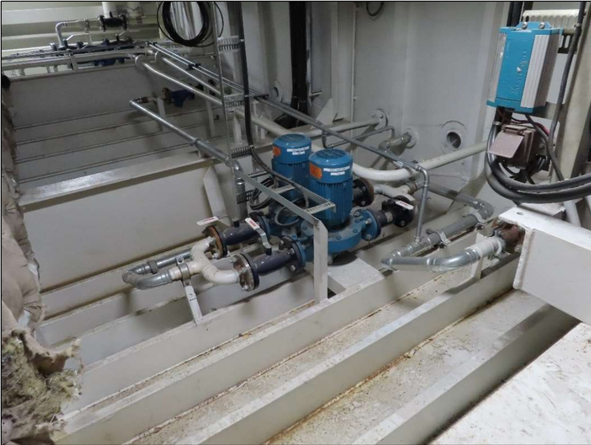
Kuva 5. Lautan peräpään konehuoneen (Nauvon pää) jäähdytuspumput. (kuva: OTKES)
