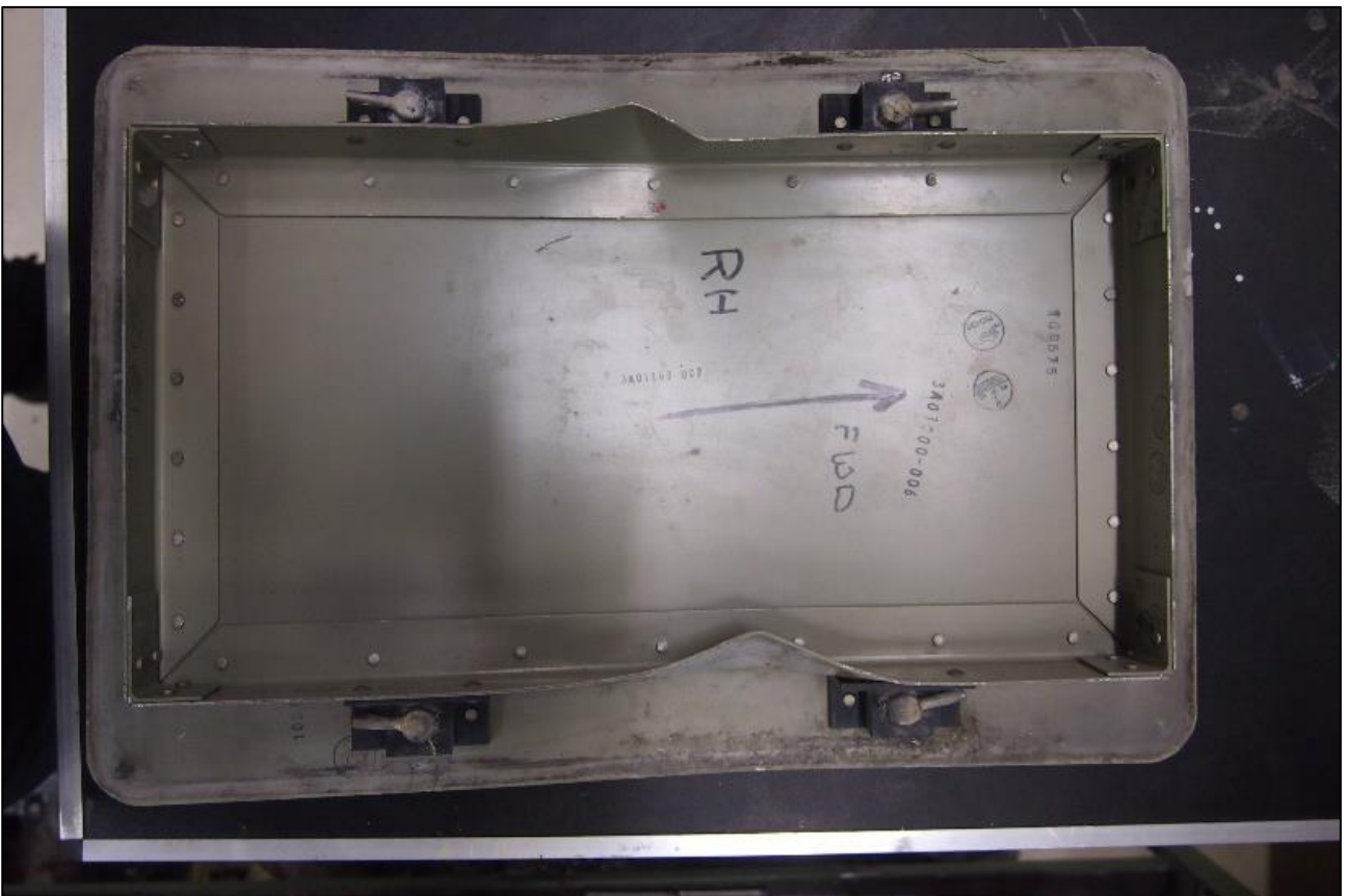
Kuva 6. Tavaratilan luukun alapuoli lukitusruuvien ollessa auki. (kuva: OTKES).
