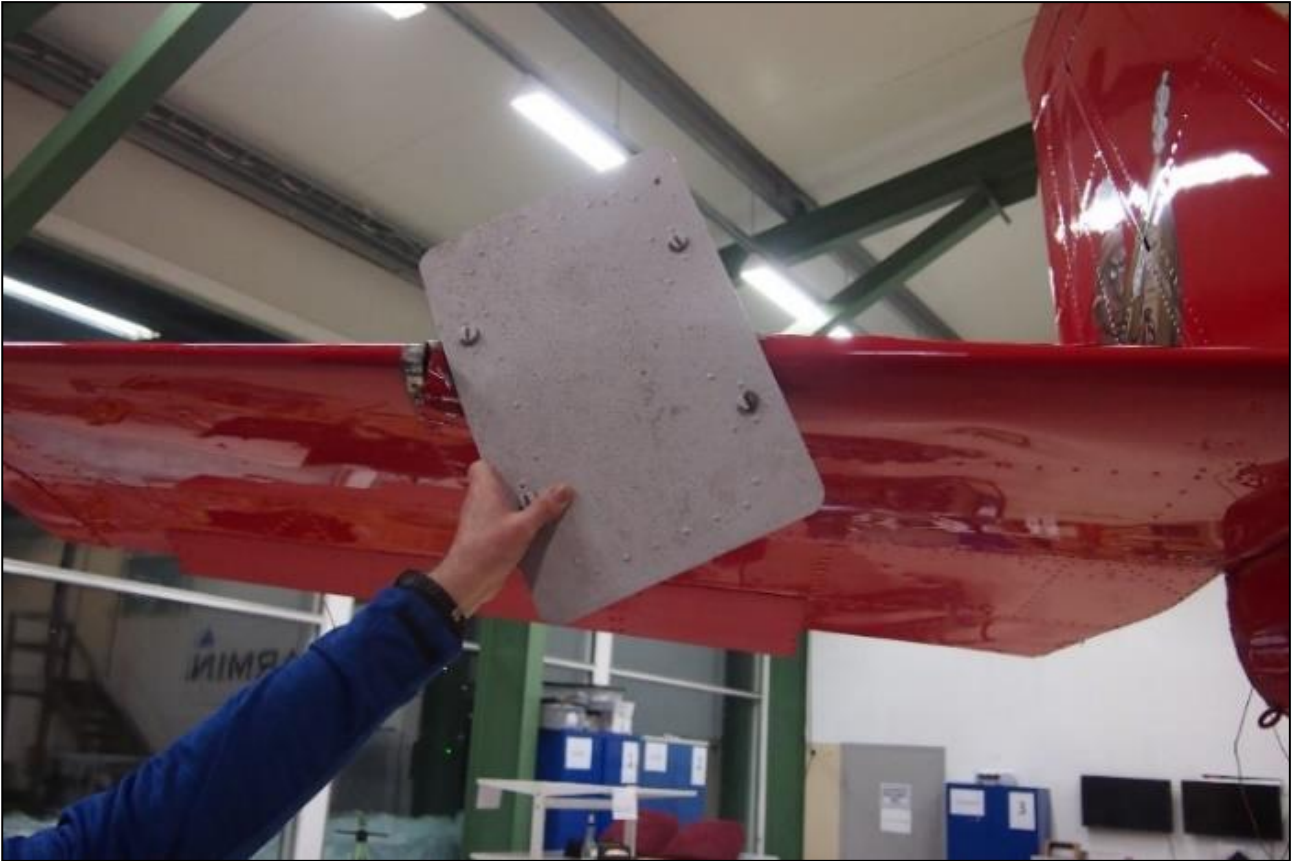
Kuva 4. Oikeanpuoleisesta kellukkeesta irronnut tavaratilan luukku sekä sen osumakohta ja -asento korkeusvakaajassa. (kuva: OTKES).
