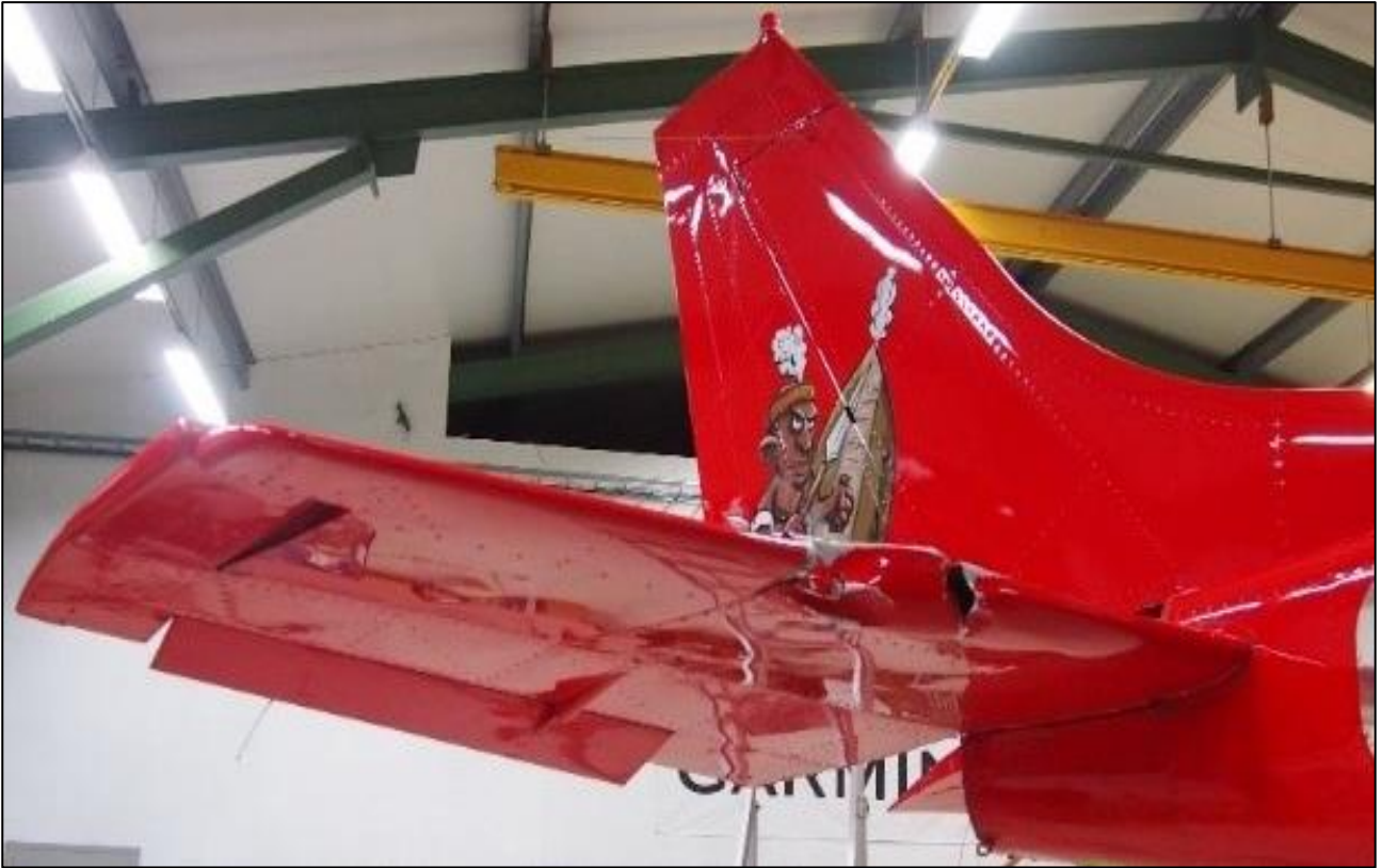
Kuva 2. Lentokoneen pyrstö ja vaurioitunut korkeusvakaaja. (kuva: OTKES).
