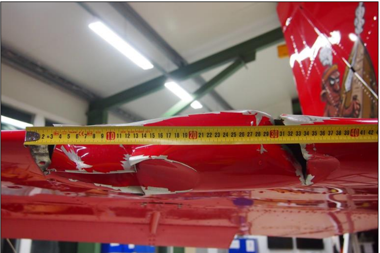
Kuva 3. Lentokoneen oikeanpuoleisesta kellukkeesta irronneen tavaratilan luukun aiheuttama vaurio korkeusvakaajassa. (kuva: OTKES).
