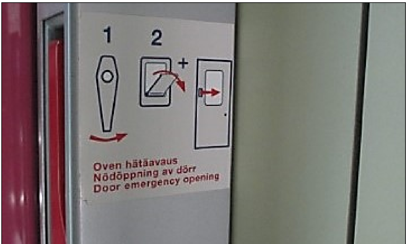
Kuva 11. Kiskobussin oven hätäavausohjeet oviaukon ja hätäavauskahvan vieressä. (Kuva: OTKES)
