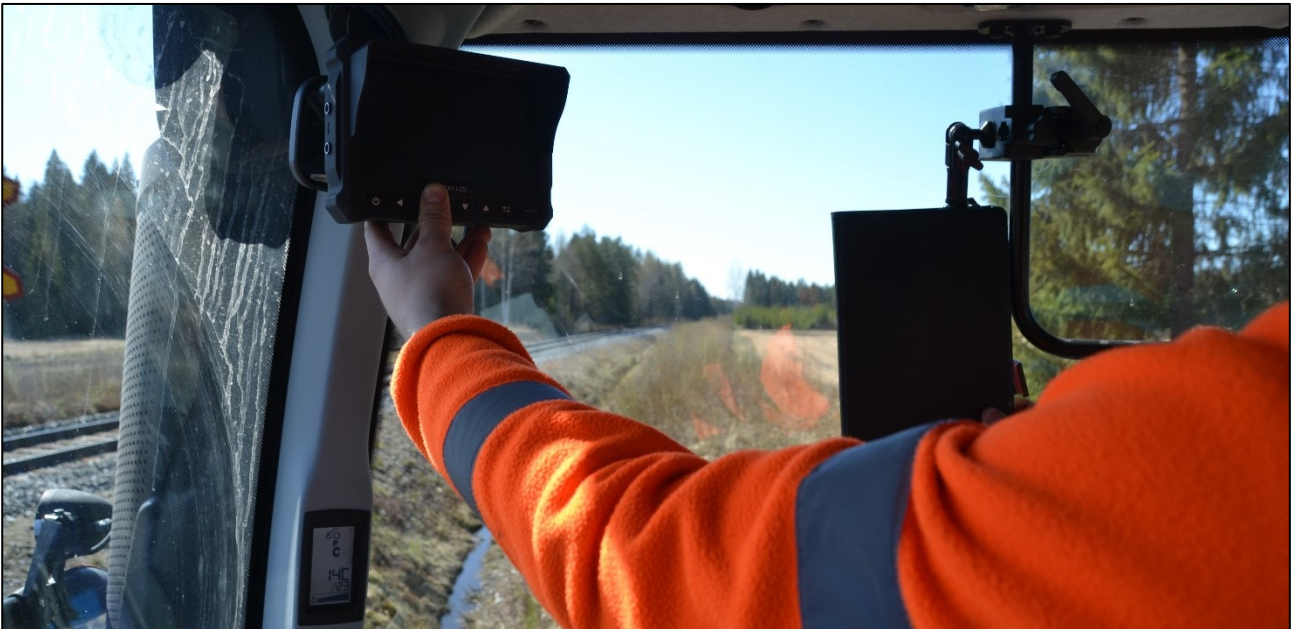
Kuva 9. Kuva onnettomuuspaikalta STOP-merkille pysäytetystä vastaavanlaisesta traktorista. Kuvassa näkyy leveä pakoputki oikeanpuoleisen A-pilarin takana sekä takakameran näyttö vasemmalla ylhäällä ja kylvölannoittimen toimintoja seuraava näyttö oikealla alempana. Takakameran näyttö irtosi onnettomuudessa kuljettajan lyötyä pänsä siihen. (Kuva: OTKES)
