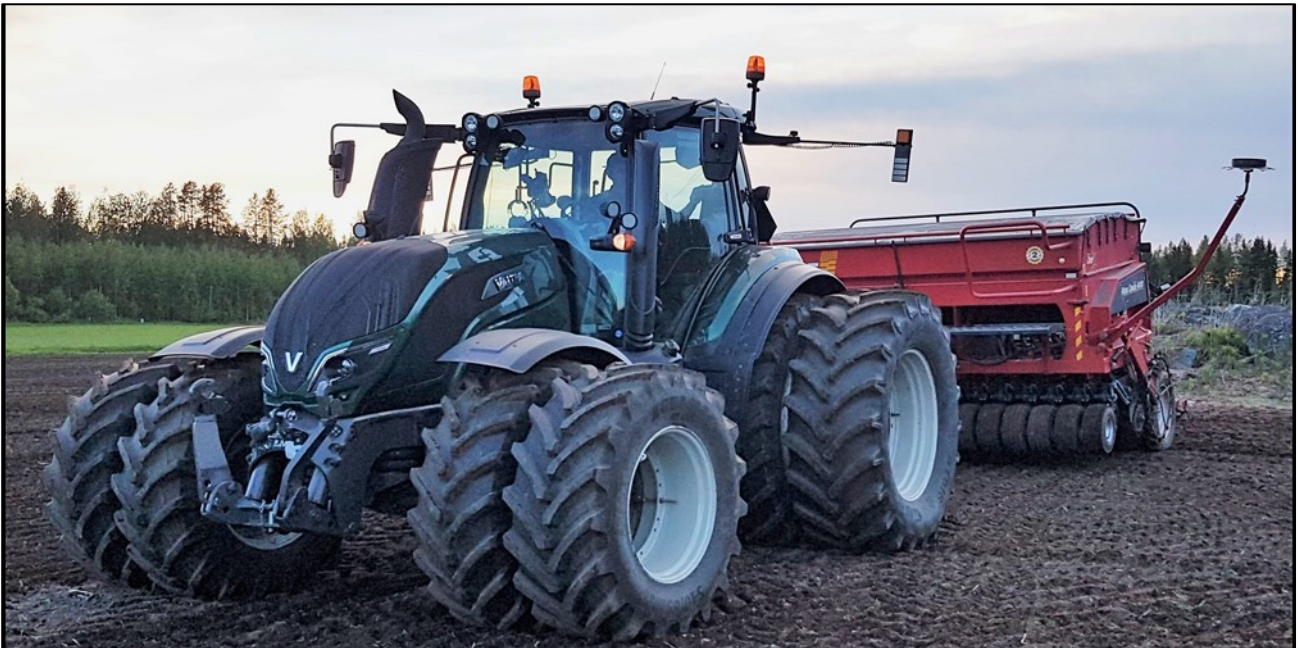
Kuva 6. Valtra 174e ja kylvölannoitin Tume SNC 4000. Traktorin etunostolaitteen kärkiosat ovat renkaiden etupuolella. Ylhäällä traktorin ulkopuolella hytin sivuilla on leveän kuljetuksen tunnusvalaisimet, jotka heijastuvat peilien kautta ohjaamoon. Lisäksi esimerkiksi mittaritossossa on valoja, jotka aiheuttavat heijastumia ikkunoihin. (Kuva: traktorin omistaja)
