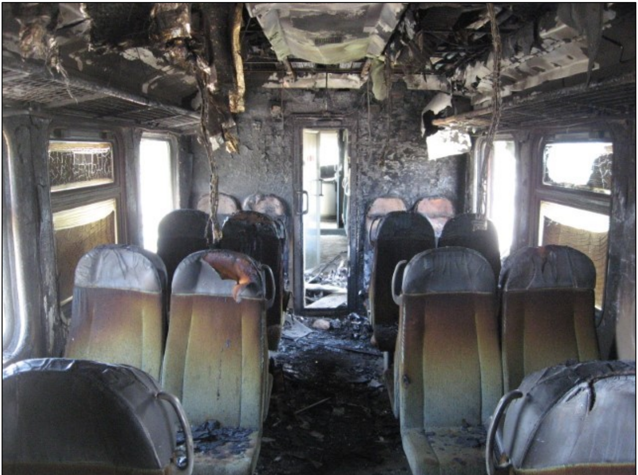
Kuva 16. Kiskobussin sisäpuolisia palovaurioita. (Kuva: OTKES)
