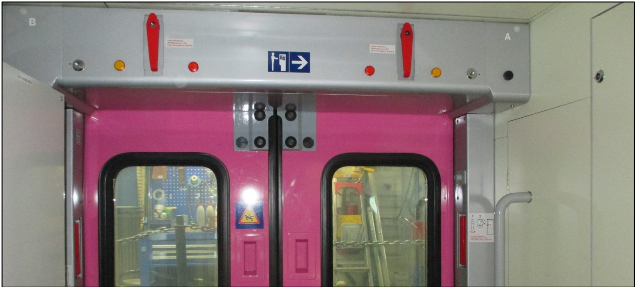
Kuva 12. Ovien punaisten hätävausvipujen sijoittelu oviaukon yläpuolella. (Kuva: OTKES)
