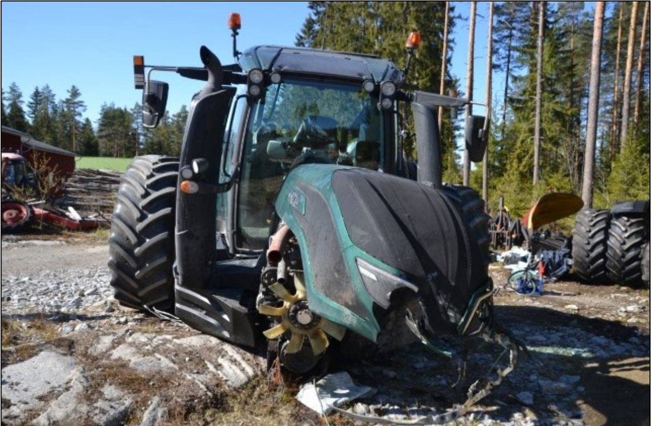
Kuva 7. Törmäyksessä traktorista irtosi muun muassa etuakselisto, moottorin kantavan öljypohjan valuteräslohko murtui ja moottori katkesi. (Kuva: OTKES)
