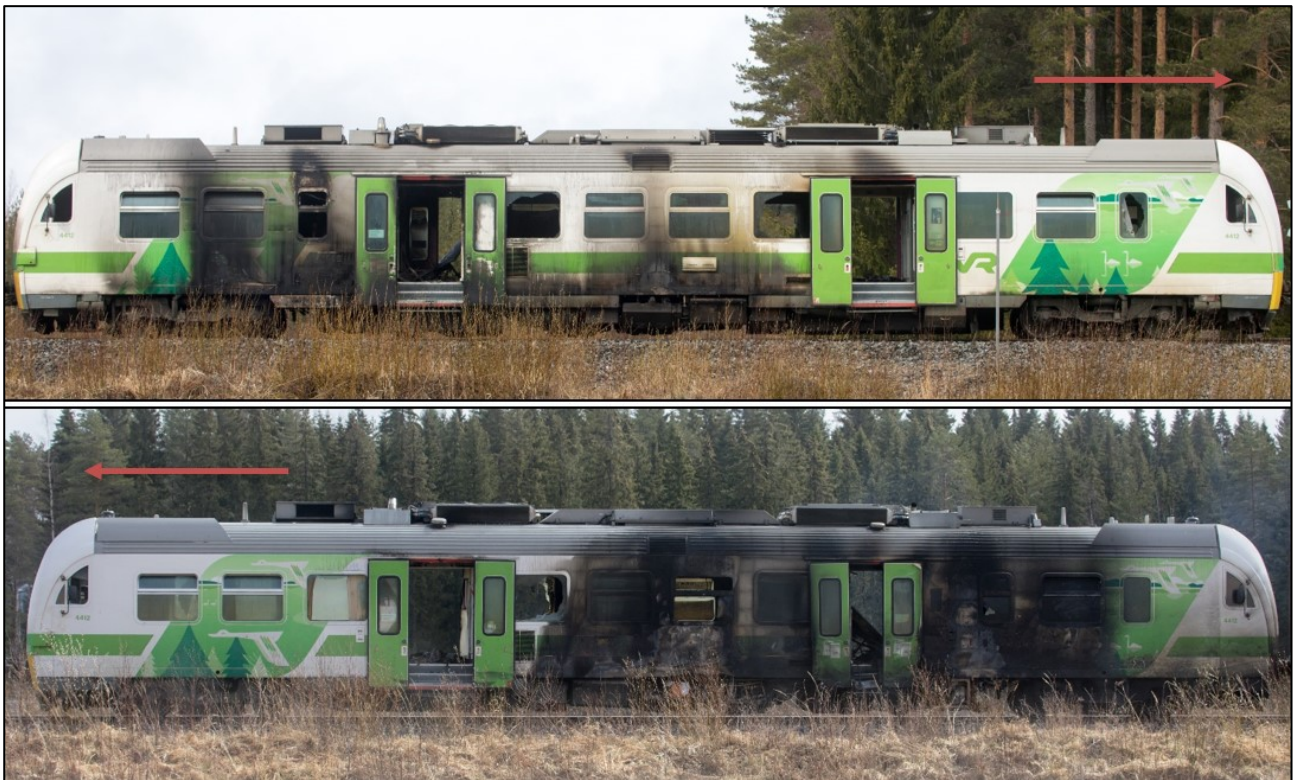
Kuva 15. Kiskobussin ulkopuoliset palovauriot. Kulkusuunta on merkitty punaisella nuolella. Ylempänä on kulkusuunnassa katsoen oikea kylki ja alempana vasen kylki. Palo syttyi kiskobussin vasemmalta puolelta. (Kuva: OTKES)
