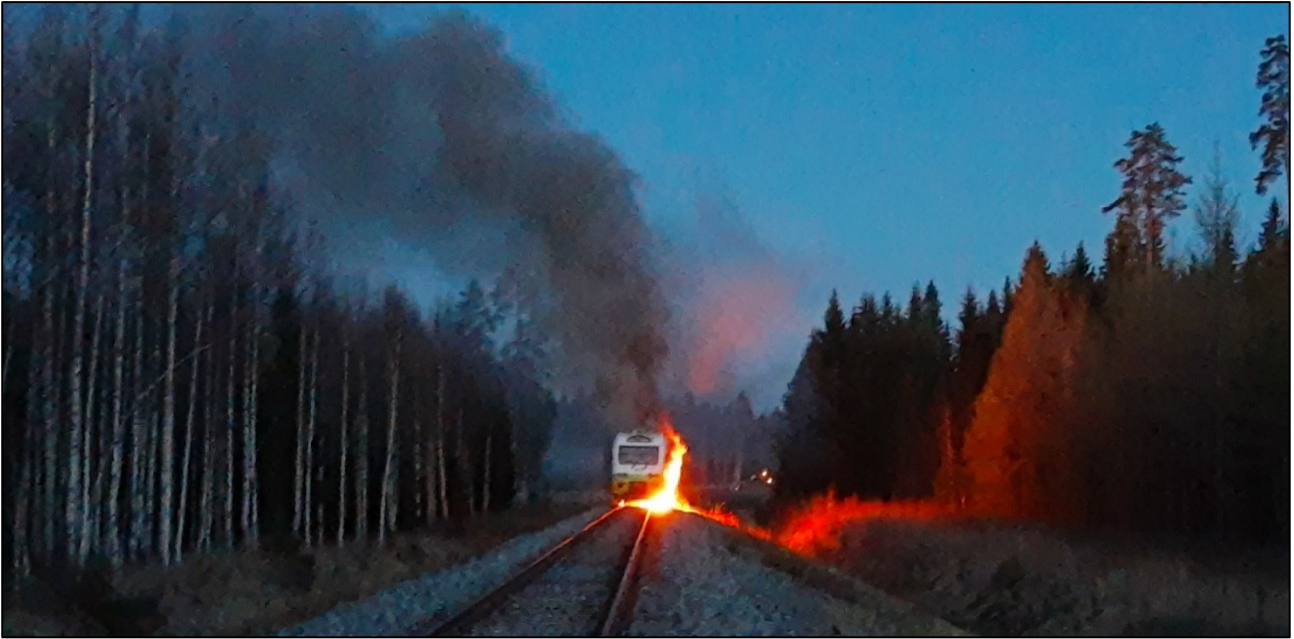
Kuva 2. Tilanne onnettomuuspaikalla kello 23.24. Veturinkuljettaja ja matkustajat ovat siirtyneet junan etupuolelle. Juna palaa kulkusuuntaan katsoen vasemmalta puolelta. Junan takana näkyy taseristeyksessä olevan traktorin valot. Traktorin ja junan välissä näkyy savupatsaita, jotka ovat syntyneet junasta radalle valuneen polttoaineen palaessa. (Kuva: junan matkustaja)
