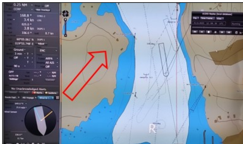
Bild 8. 12:04:36 I det här skedet är manövern ännu normal, sidoavdriften är 0,7° och vinden ökar. Farten akteröver fortfarande 3,4 knop. Vind 24 m/s från riktning 220°.
