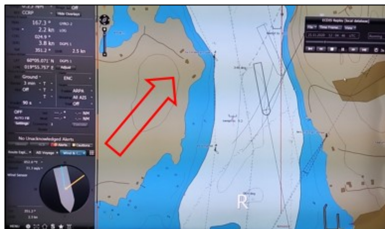
Bild 9. 12:04:46 Mellan 14:04:36 och 12:04:46 visas att vindhastigheten går över 27 m/s och avdriften ökar till 2,5°. Farten akteröver minskar. Prediktor och vektor visar alltmer mot stranden hädanefter.
