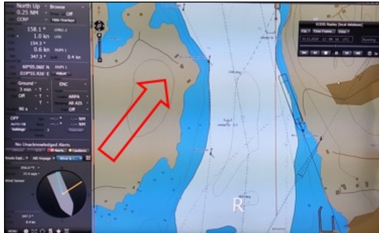
Bild 13. 12:08:56 Fartyget ligger mot stranden. Vindhastigheten har just varit 25 m/s med riktning 209°.
