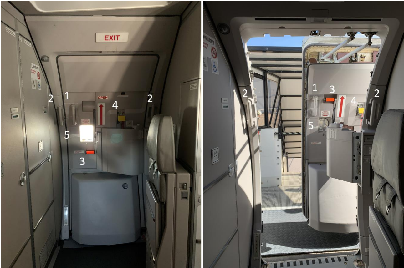
Bild 1. Vänster framdörr på ett flygplan av typen A320 stängd och delvis öppen. Dörrrens delar har markerats med siffror på bilden enligt följande: 1. Dörrrens hjälphandtag, 2. Hjälphandtag i dörrkarmen, 3. Dörrrens öppningshandtag, 4. Handtag för säkring av nödrutschkana, 5. Kontrollfönster. (Bild: OTKES)
