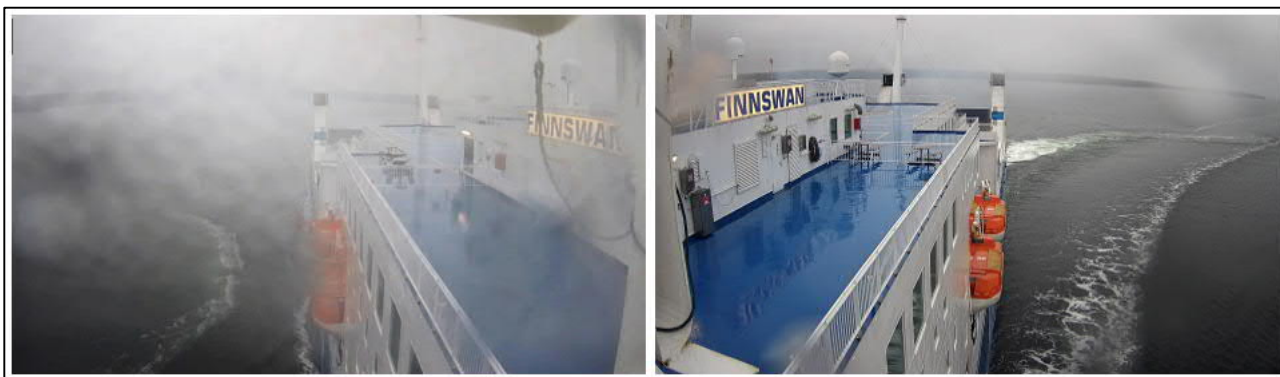
Kuva 3. Merguksen käännöksen vanavesi näkyy hyvin Finnswanin valvontakameran pysäytyskuvassa vasemmalla. Oikeanpuoleisessa kuvassa Finnswanin asento väistöliikkeen aikana samalla hetkellä, kun Mergus on keulan oikealla puolella kaikkein lähimpänä. Vasemmanpuoleisen kuvan ajanhetki on noin 20 sekuntia oikeanpuoleista myöhemmin. (Kuvat: Finnlines)
