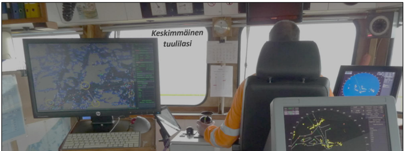
Kuva 8. Merguksen ohjaamoon näkemäesteitä taemman ohjauspisteen vierestä kuvattuna. Ruorimies istuu etummaisessa ohjauspisteessä, josta käsin integroitua ohjauskahvaa (käsiuori & tehonsäädöt) käytetään vasemmalla kädellä. Kahvan vieressä vasemmalla on autopilotin kosketusnäyttö. Kuvan henkilö ei liity tutkittavaan tapaukseen. (Kuva: OTKES)
