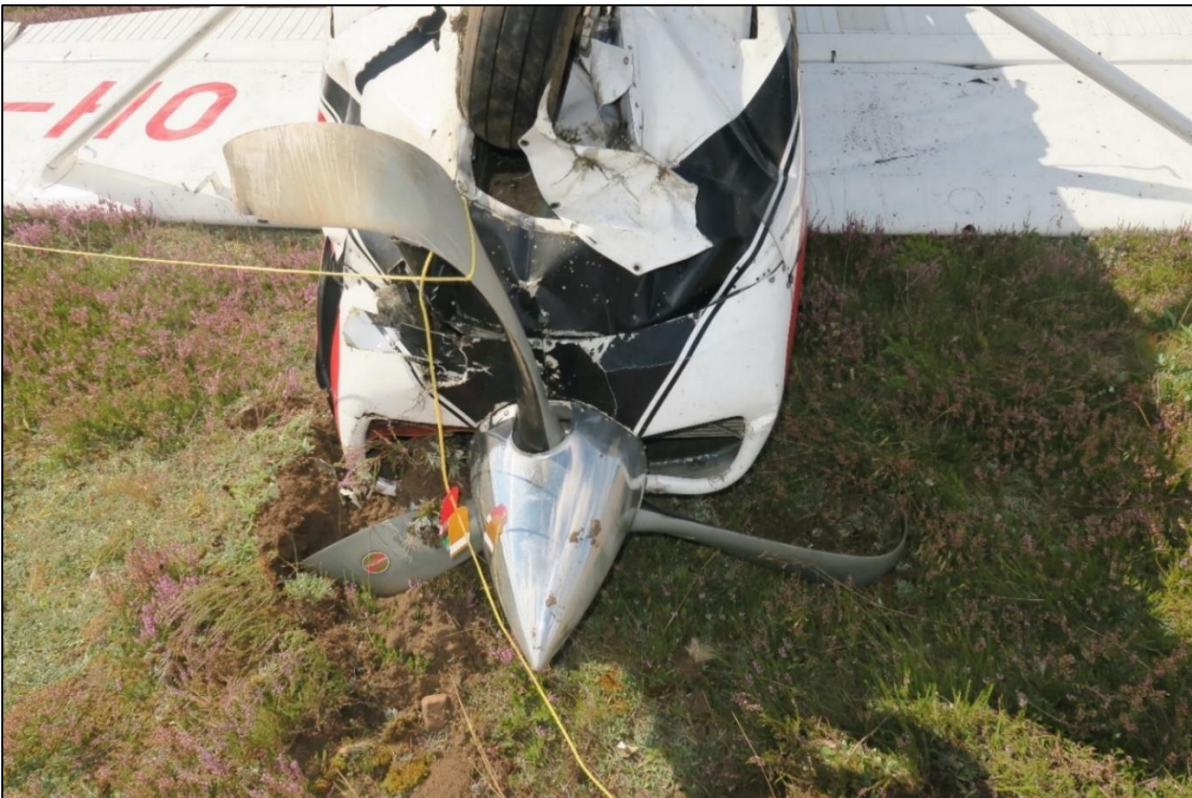
Bild 5. Bladen på flygplanets propeller böjdes när planet störtade. (Bild: Polisen)
