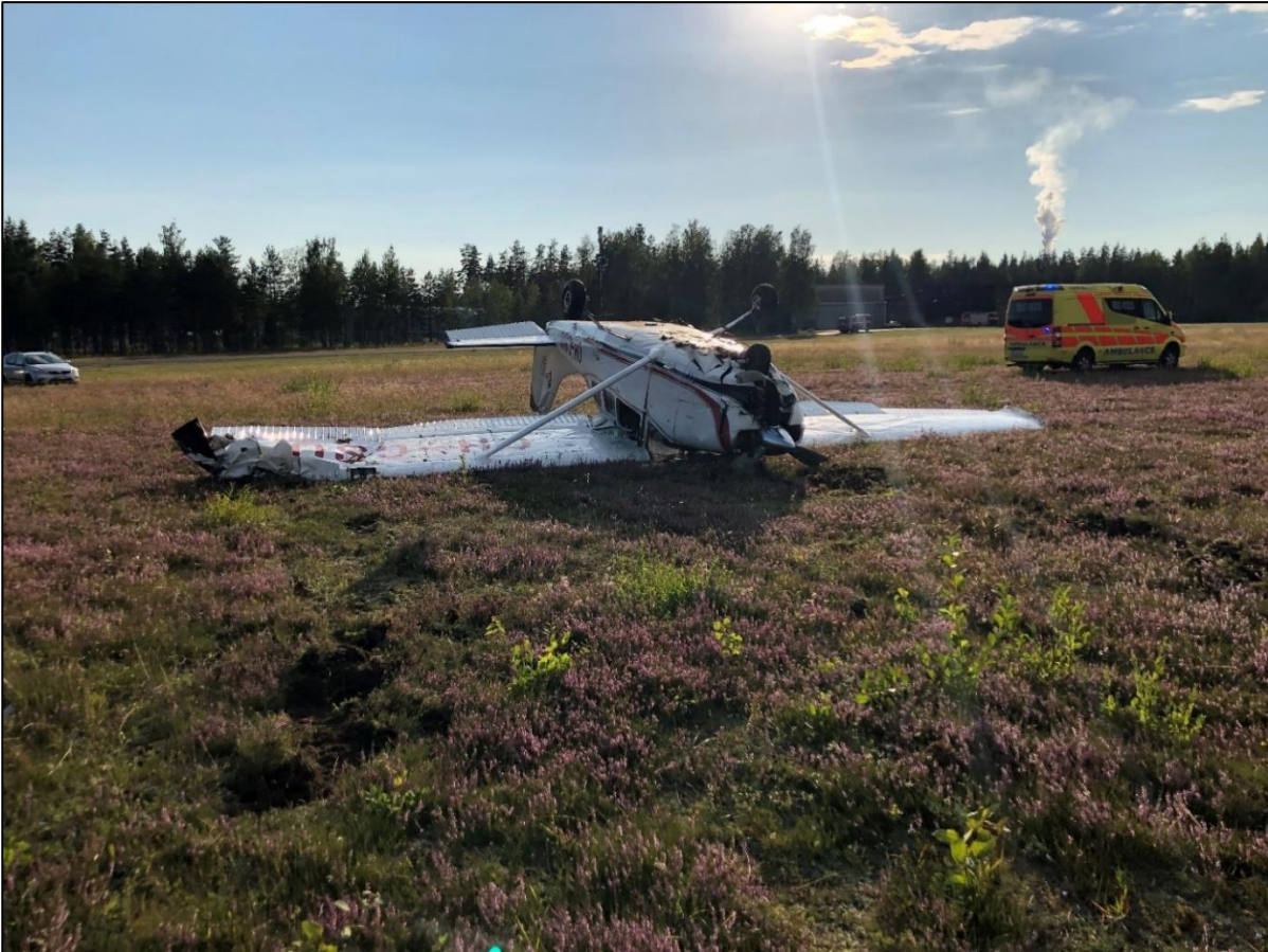
Bild 4. Flygplanet efter olyckan. Nosstället har tryckts in i skrovet och den vänstra vingspetsen och propellern har skadats. (Bild: Pilotens bildmaterial)
