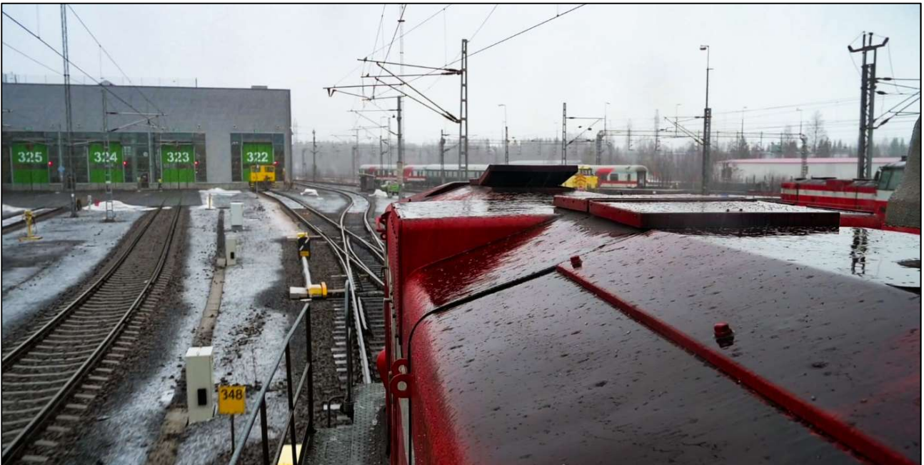
Kuva 11. Veturinkuljettajan paikalta katveeseen jäävät opasteet ja muut laitteet ovat hyvin näkyvissä veturin vasemmalta puolelta. (Kuva: OTKES)
