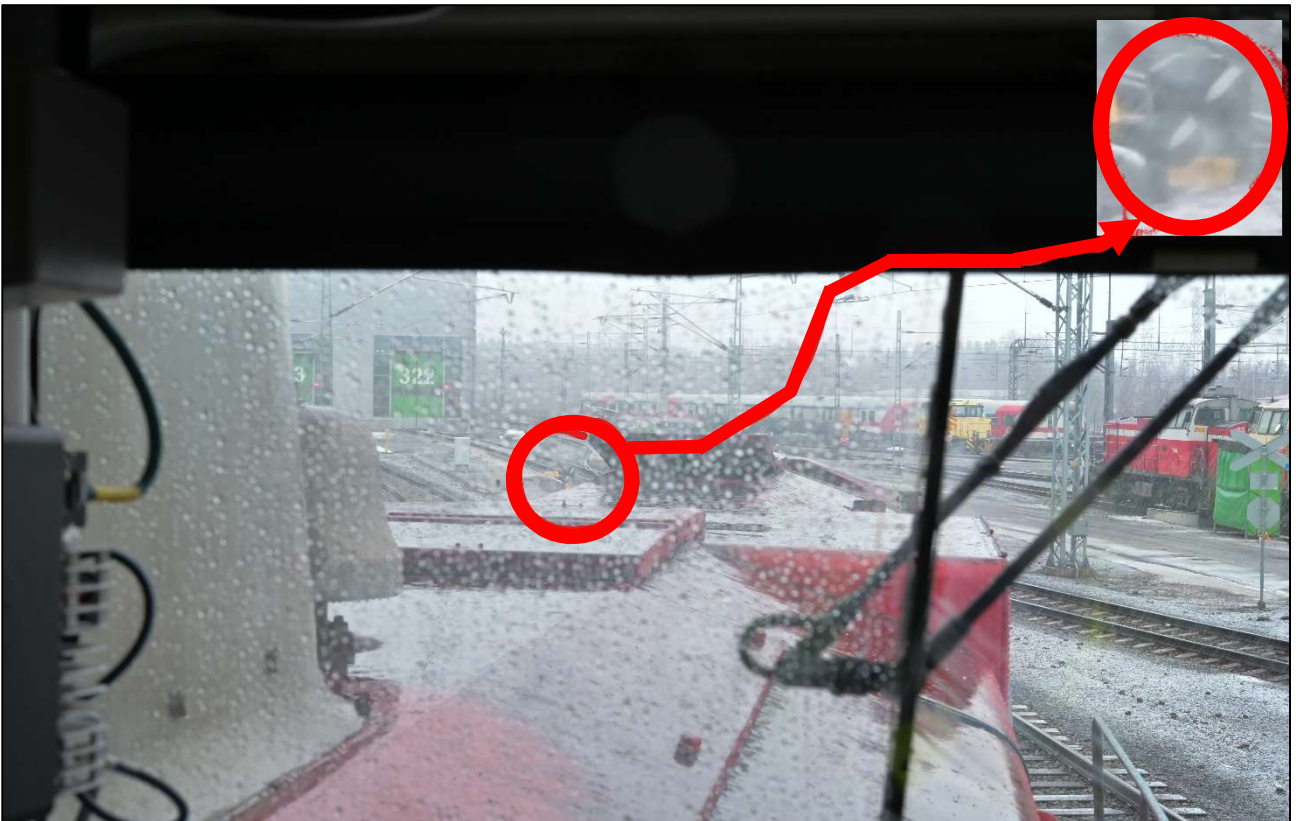
Kuva 6. Näkymä vaihteen V350 mekaaniselle asennonilmaisimelle Dv12-veturin oikealta puolelta, kuljettajan paikalta. Tämä näkymä on seisontakorkeudelta pyyhkimen puhdistaman alueen ulkopuolelta. Etäisyys asennon ilmaisimelle noin 80 metriä. (Kuva: OTKES)
