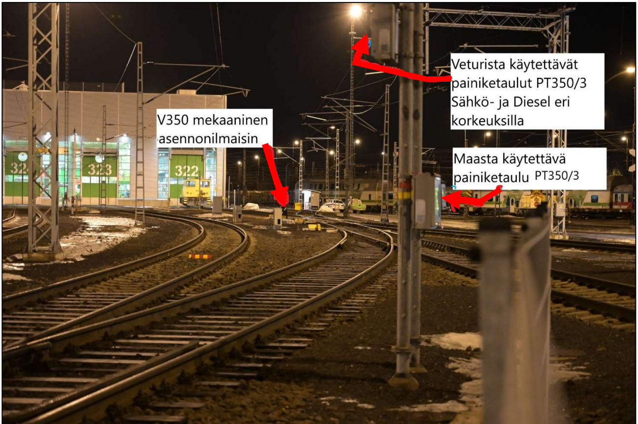
Kuva 9. Valaistus 17.2.2020 kello 21.38. Etualalla V348 ja V350 painiketaulut, taustalla 80 metrin etäisyydellä V350 (Kuva: OTKES)
