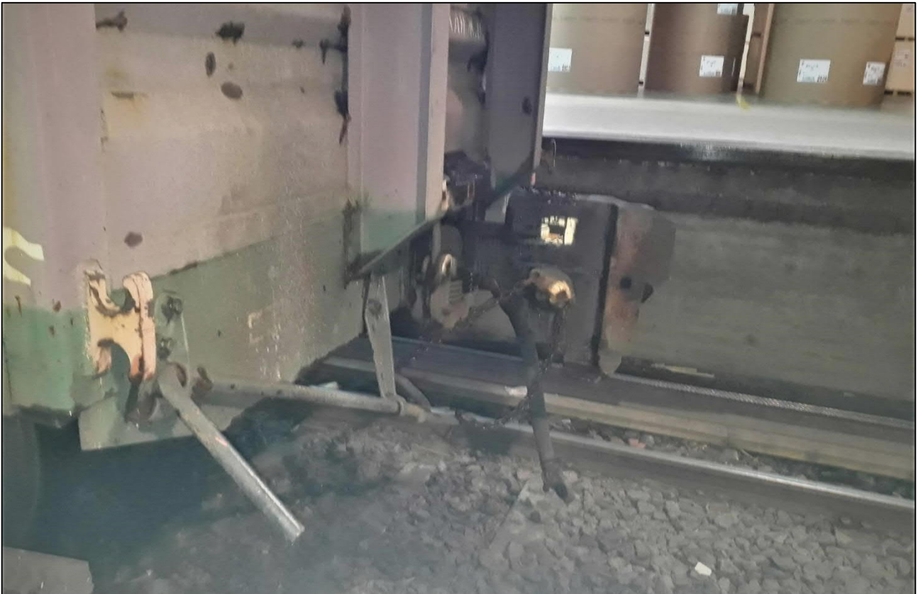
Kuva 2. Heti onnettomuuden jälkeen otettu kuva Vgk-vaunun SA3-kytkimestä, joka irtosi Hkba-vaunun SA3-kytkimestä. Irrotustangon asento on irrotusasennon ja normaalitilan välillä. (Kuva: VR Transpoint)
