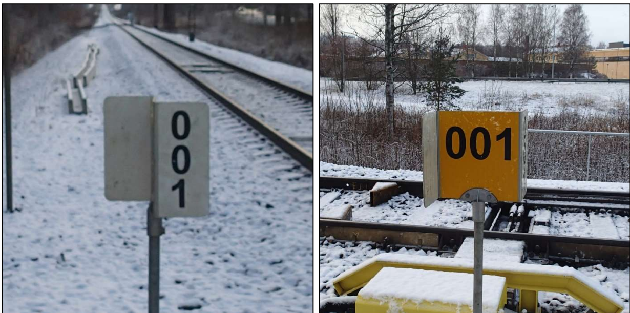
Kuva 3. Vaihteen V001 merkki. Vasemmalla valkoinen pinta näkyvissä, oikealla keltainen pinta näkyvissä. (Kuva: OTKES)
