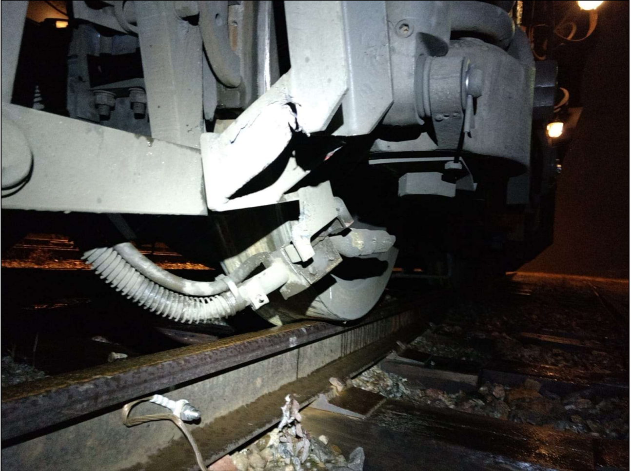
Kuva 2. Veturin hiekoitinlaitteisto vaurioitui törmäyksessä. (Kuva: Fenniarail)
