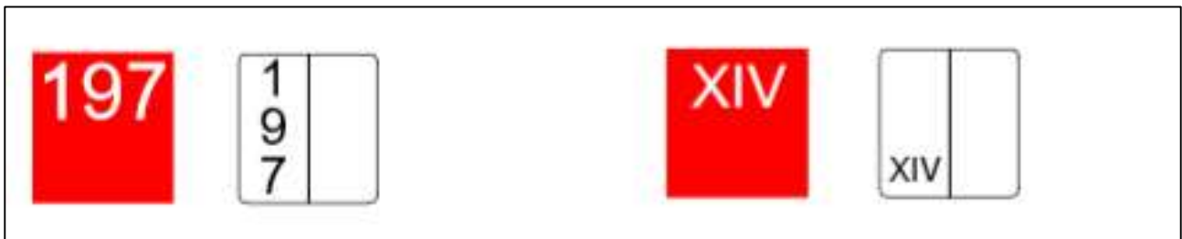
Kuva 8. Merkin punainen taustaväri ja vaakasuuuntainen numero osoittavat, että raiteensulku tai pysäytyslaite on liikennöinnin estävässä asennossa. Merkin valkoinen väri ja pystysuuuntainen numero osoittavat, että raiteensulku tai pysäytyslaite ei ole liikennöinnin estävässä asennossa. (Kuva: Väylävirasto Junaliikenteen ja vaihtotyön turvallisuussäätöt )
