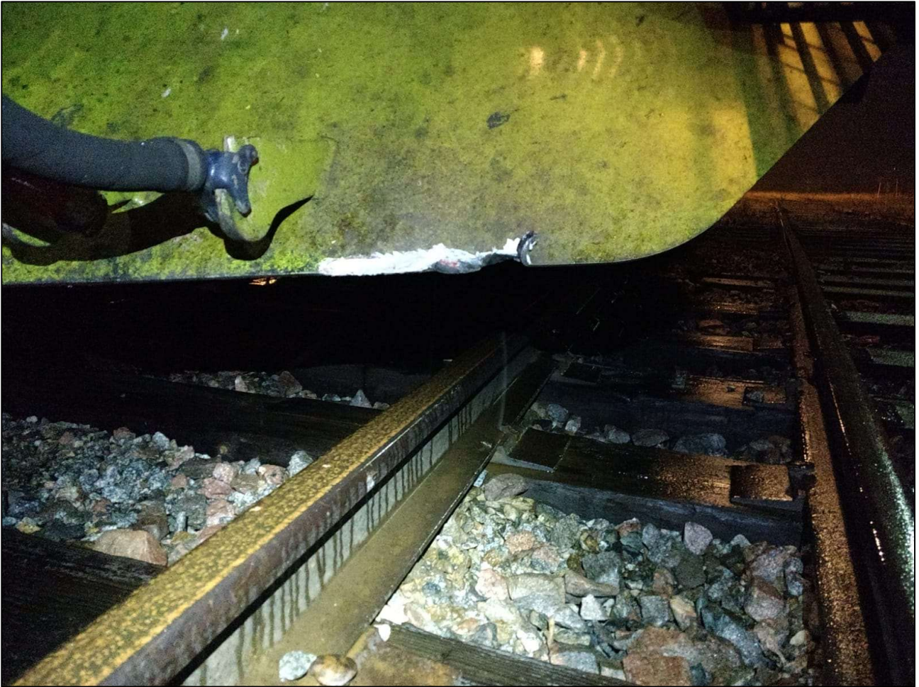
Kuva 1. Esteenraivaajassa näkyy raiteensulun jättämä törmäysjälki. (Kuva: Fenniarail Oy)
