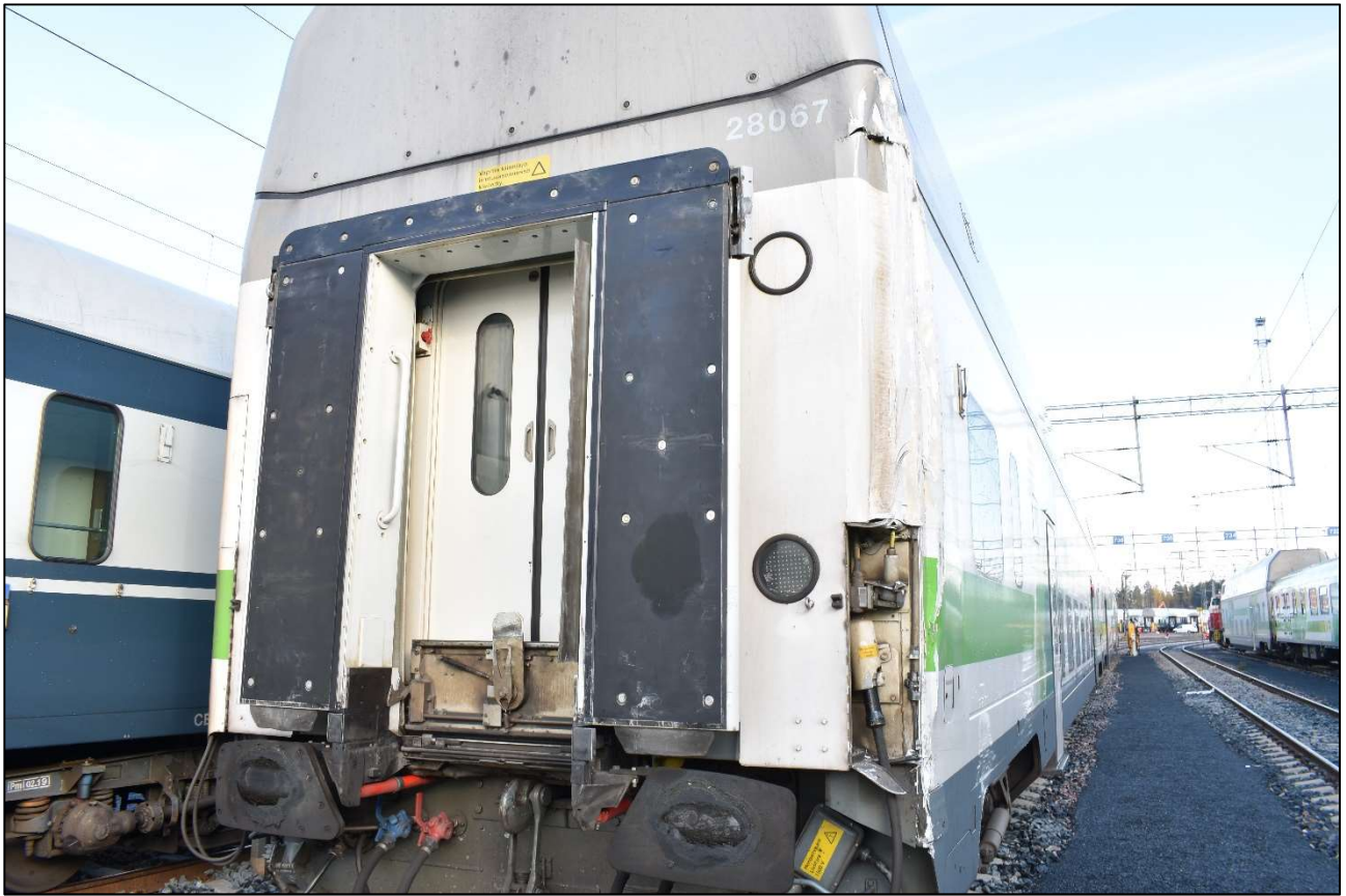
Kuva 2. Törmäyksessä vaurioitunut vaunu 2-kerroksinen Ed-päivävaunu. (kuva: OTKES)
