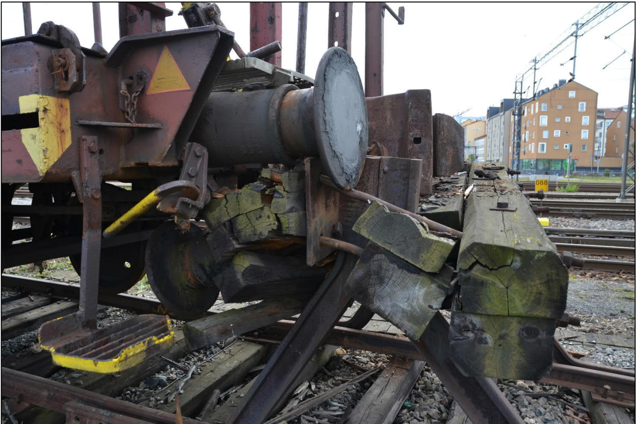
Kuva 2. Särkynyt raidepuskin ja sen päälle nousseet Hkba-vaunun puskimet. (Kuva: OTKES)
