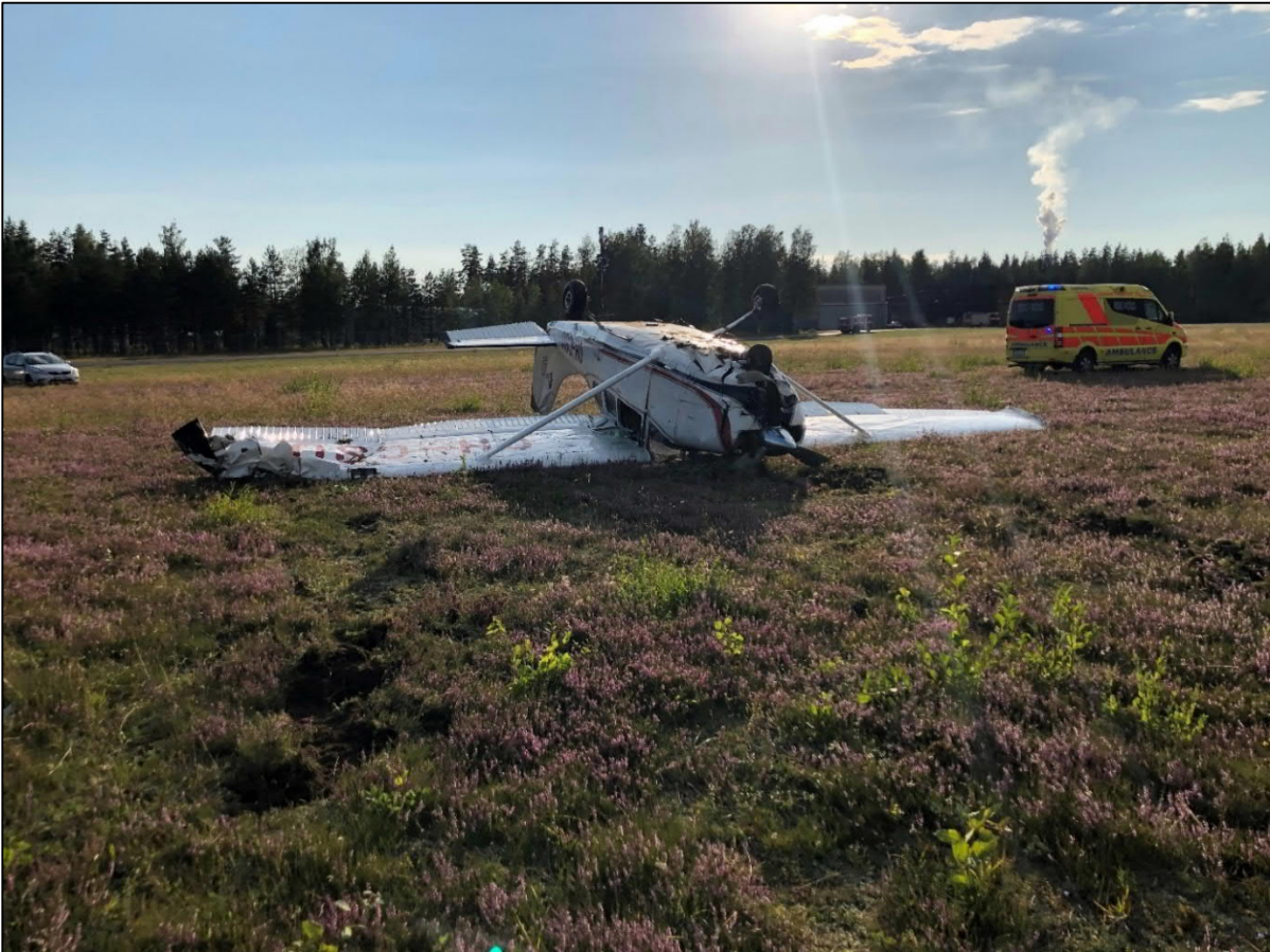
Kuva 4. Lentokone onnettomuuden jälkeen. Nokkateline on painunut rungon sisään ja vasen siiven kärki ja potkuri ovat vaurioituneet. (Kuva: Koneen lentäjän kuvamateriaali)
