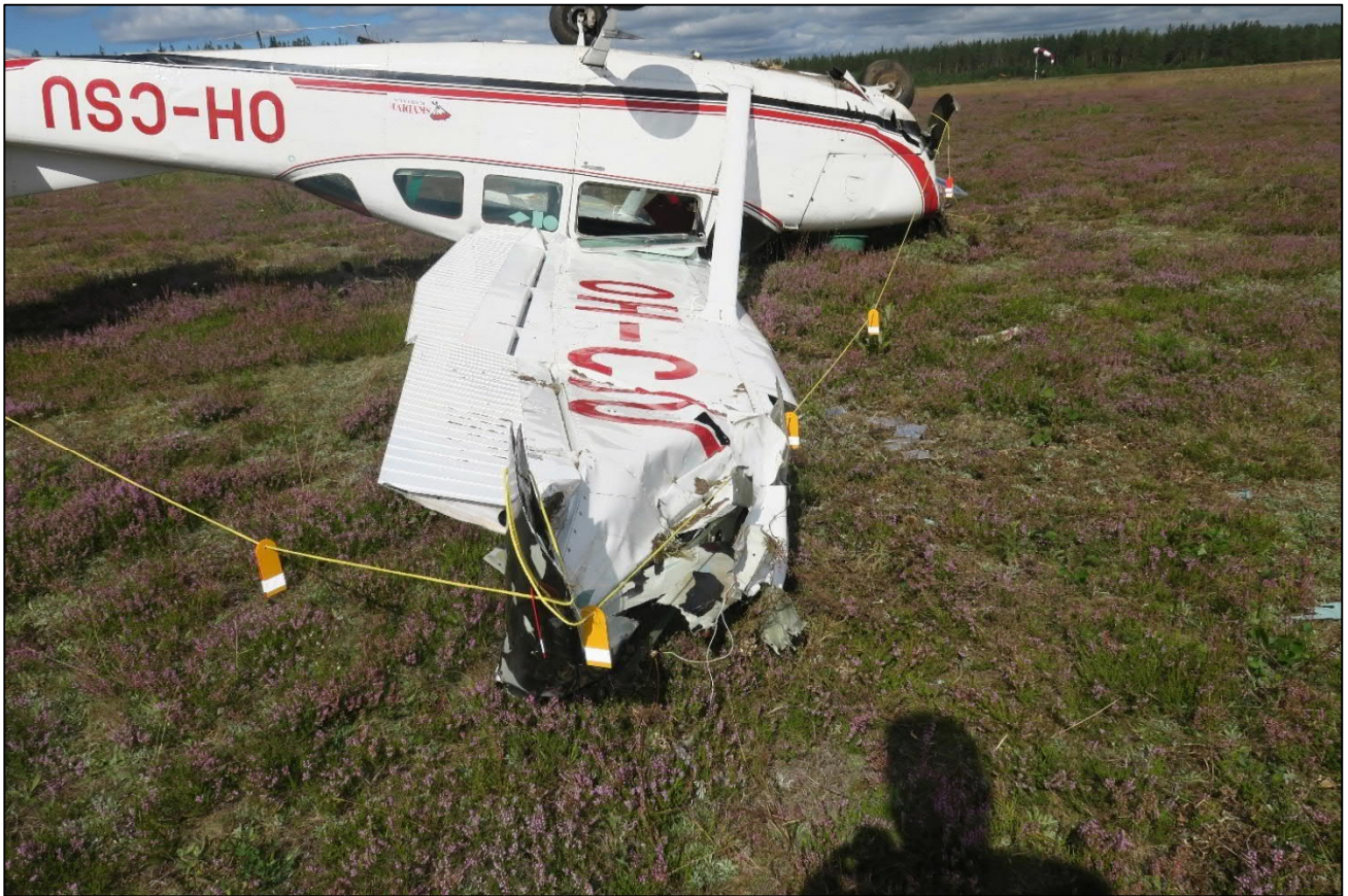
Kuva 6. Vasen siivenkärki repesi törmäyksessä monesta kohtaa ja vääntyi. (Kuva: Poliisi)
