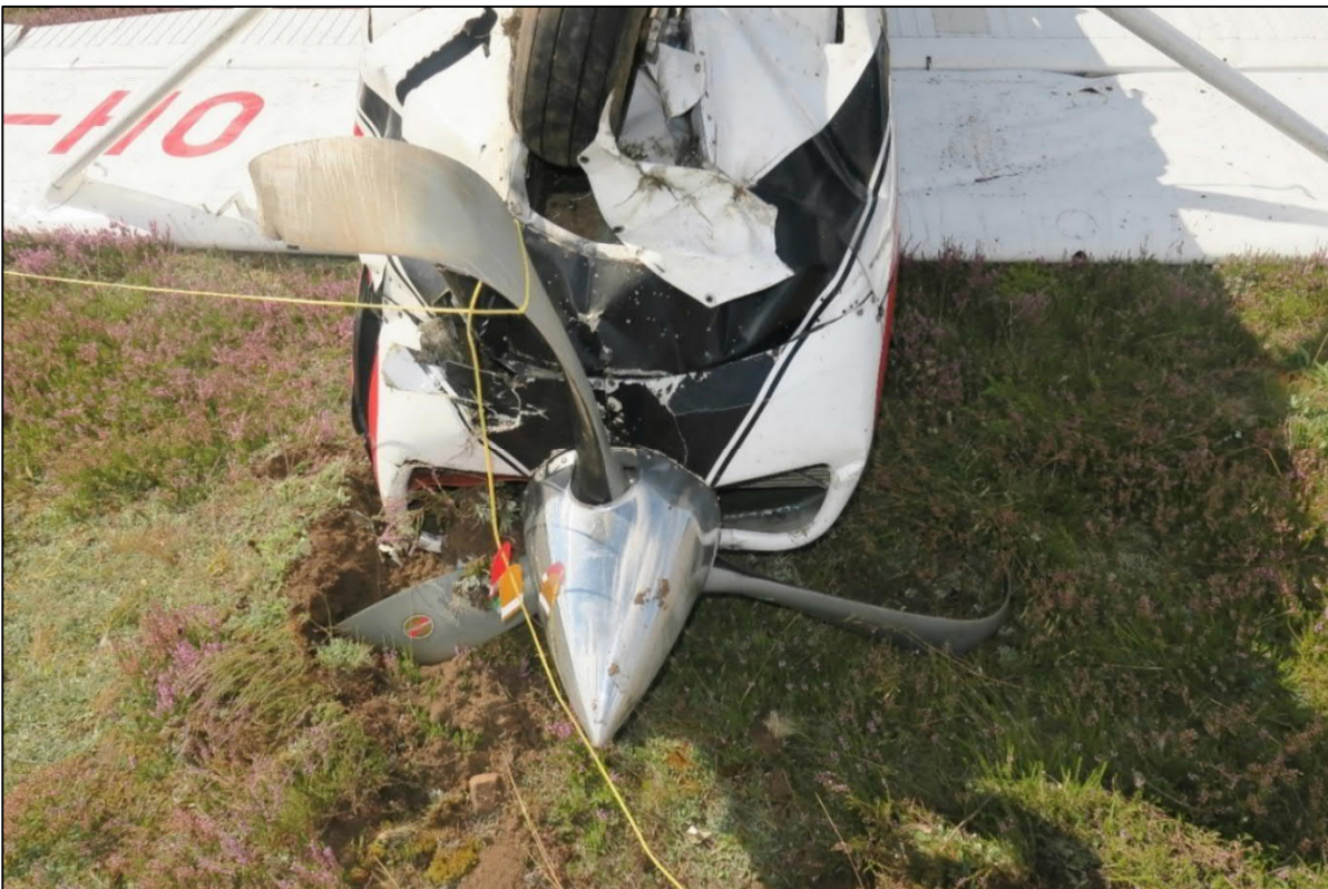
Kuva 5. Lentokoneen potkurin lavat vääntyivät törmäyksessä kaarelle. (Kuva: Poliisi)
