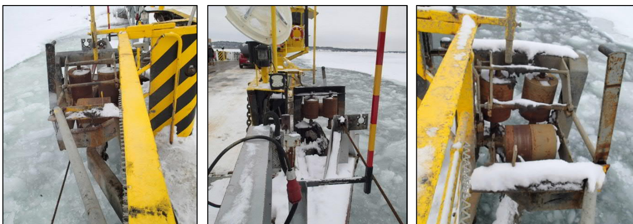
Bild 13. De rullar via vilka styrvajern går finns på vajerfärjans sida. Under fotograferingstidpunkten var inte vajern kopplad till vajerfärjan på grund av isförhållandena. Vid tidpunkten för olyckan fanns det inte is. (Bilder: Olycksutredningscentralen)
