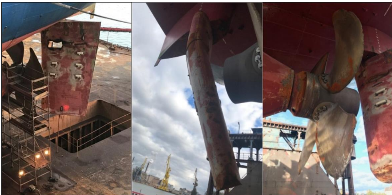
Bild 4. Fartygets skadade roder till vänster, den deformerade roderhjärtstocken i mitten och den skadade propellern till höger. (Bilder: Leonhardt & Blumberg, Shipmanagement GmbH & Co. KG)
