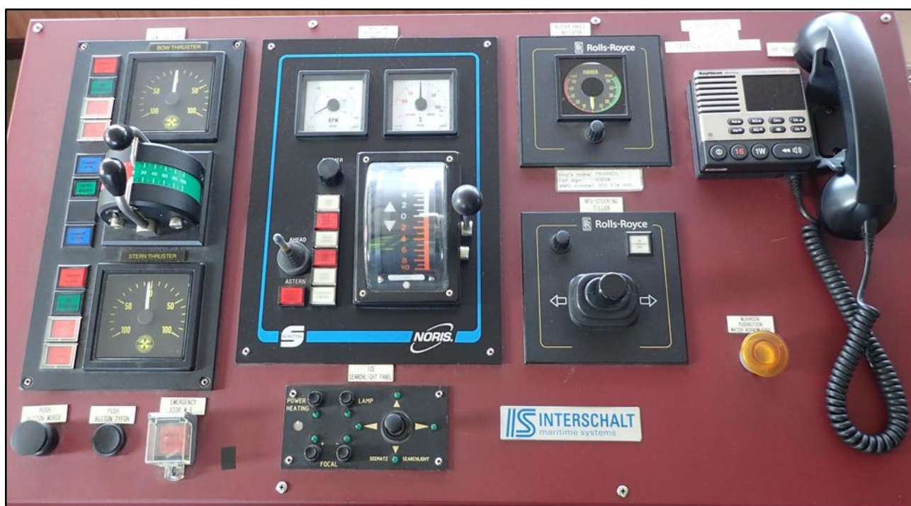
Bild 13. Närbild av pulpeten på styrplatsen på vänstra vingen vid vilken lotsen manövrerade fartyget. Nere till vänster display och reglage för styrpropellern i aktern, uppe reglage och display för styrpropellern i fören. I mitten reglage för huvudmaskinen och propellern samt ovanför dem till vänster varvtalsmätare (huvudmaskin och propeller) och till höger mätare för propellerns stigning. Till höger reglage och display för rodret samt telefon. (Bild: OTKES)
