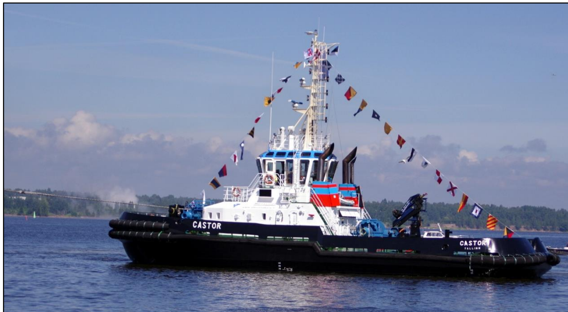
Bild 7. Bogserbåten Castor. Castors längd är 34,5 m, bredd 12,10 m, djupgående 4,5 m och dragkraft SBP 65 ton. (Bild: Alfons Håkans AS)
