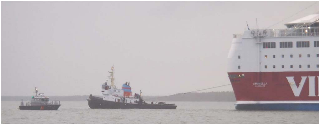
Bild 29. Bogserbåten HARALD säkerställer att AMORELLA:s akter hålls på plats. Patrullbåt PV 265 säkrar. Bild: PV 262.
