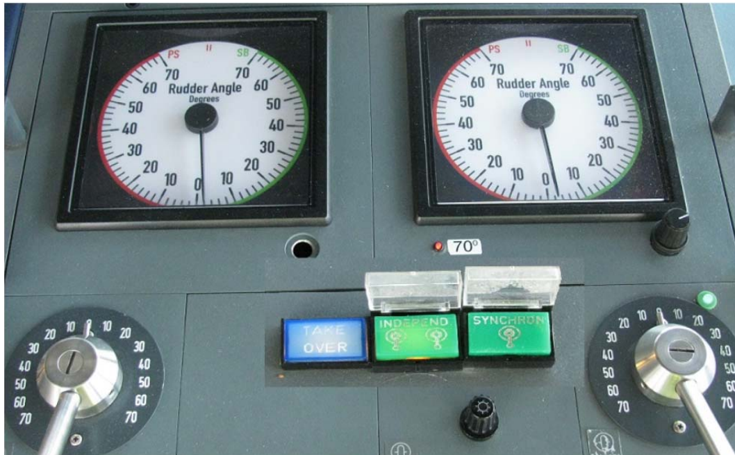
Bild 4b. Rodervinkelindikatorerna och instrumentpanelen på bryggvingens manövreringspulpit. De gröna knapparna är för val av roder: den vänstra – styrningen oberoende det andra rodet, den högra – roden synkroniserade att vända samtidigt.
