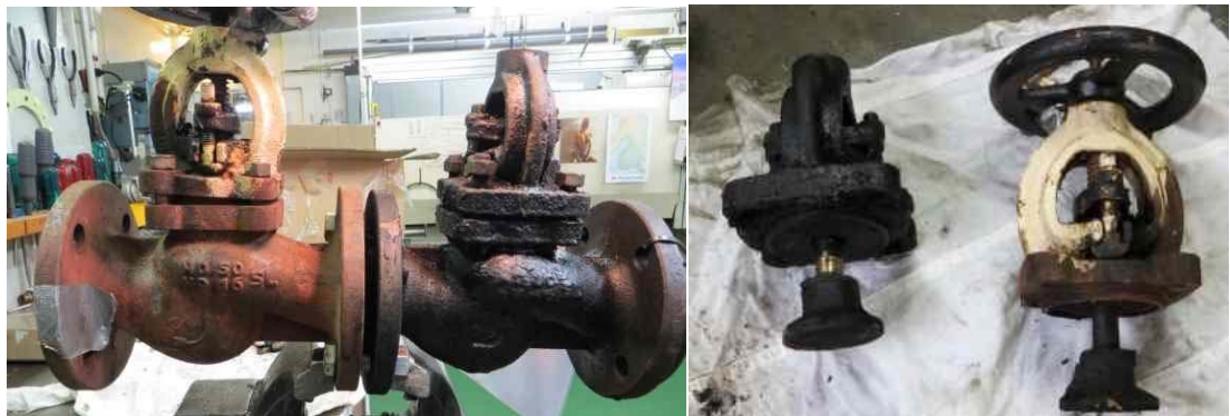
Bild 31a. Till vänster ventilerna från sidan – till höger spindlarna och ventiltallrikarna, den ena bruten.
