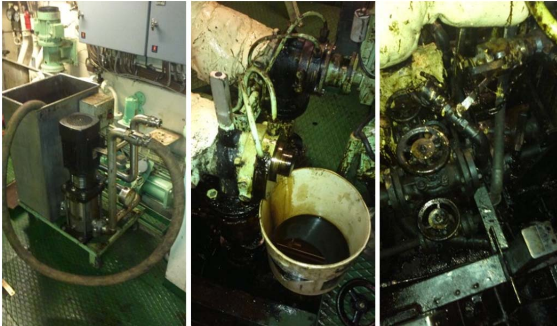
Bild 16b. Till vänster tvättutrustning för hjälpmaskinernas HFO-förmärare, i mitten viskosimeterns monteringsfläns vilken sprang läck och till höger HFO-kontaminerat slagvatten nära läckaget. Fotograferat 16-17.12.2013.
