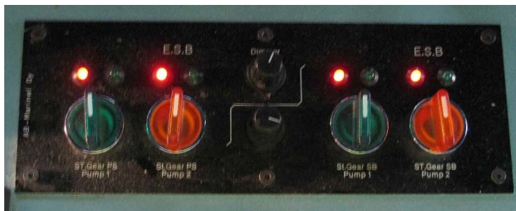
Bild 10b. Kontakterna i styrpanelen för start av rodermaskinernas pumpar. De röda kontakterna är kopplade till nöd-elnetet.
