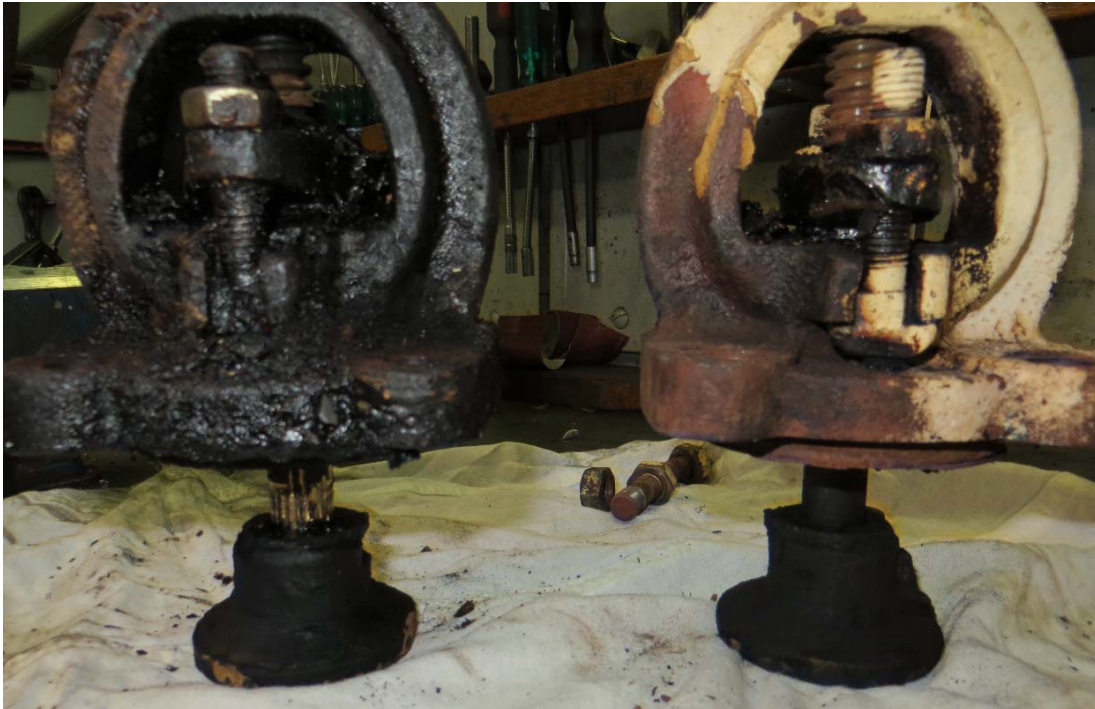
Bild 31b. Till vänster ventilen vars spindel var av. I ventiltallriken ska man se arbetsspår vilka har uppstått då ventilen öppnades med ett verktyg. Spindeln hade brustit vid det första försöket.
