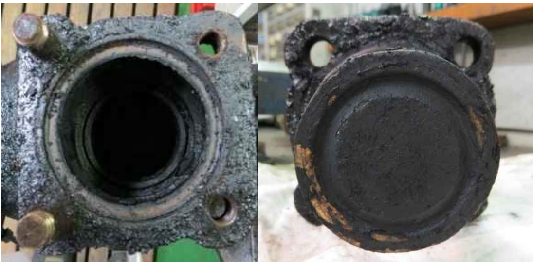
Bild 31c. Den skadade ventils kägla (till vänster) och ventiltallriken till höger.
