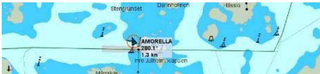
Bild 25d. Klockan 12:37:15 står fartyget på grund, rörelseriktningen är mot babord då svängningen fortsätter av tröghetskraften runt girpunkten i fören.
