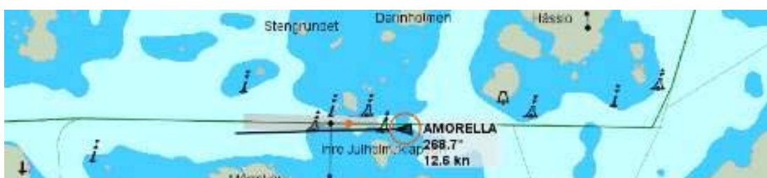
Bild 25a. Cirka 1,5 minuter efter den bedömda tiden för elstörningens början och propellerns stannande, klockan 12:34:22, svängde fartyget mot babord av bankeffekten i farleden. Strax innan detta kopplade linjelotsen nödstyrningssystemet och svängde roden till styrbod. Hastigheten var 12,6 knop.
