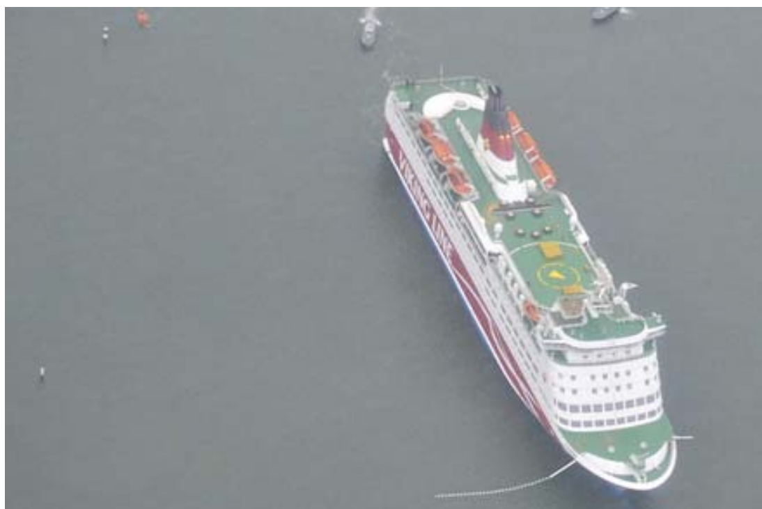
Bild 20. AMORELLA på grund med SB-ankaret nere. Akter om fartyget ses propeller-virvlar. Man ville hindra fartyget från att glida av grundet genom att använda SB-propeller. Ankarkättingen framhåvs i bilden. Bild: Gränsbevakningen.
