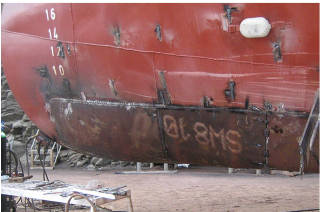
Bild 12. Sidoplåtar på babordssidan ersätts med nya. (Foto: Olycksutredningscentralen)
