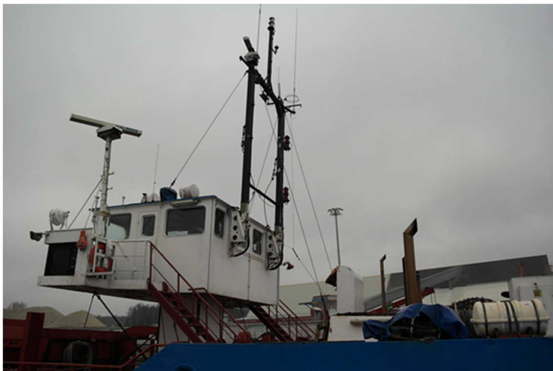
Bild 2. Byggstrukturen i fartygets akter. Passage till styrhytten yttre vägen. (Foto: Olycksutredningscentralen)
