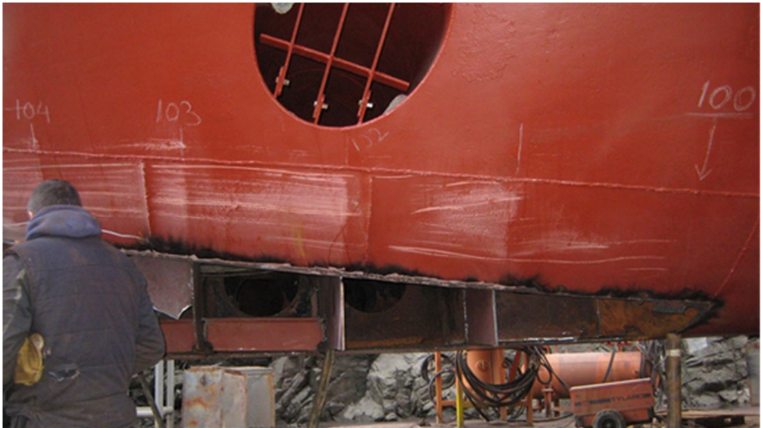
Bild 11. Dockningsfoto. Revan på babordssidan öppnad, spanten förstärkta. (Foto: Olycksutredningscentralen)
