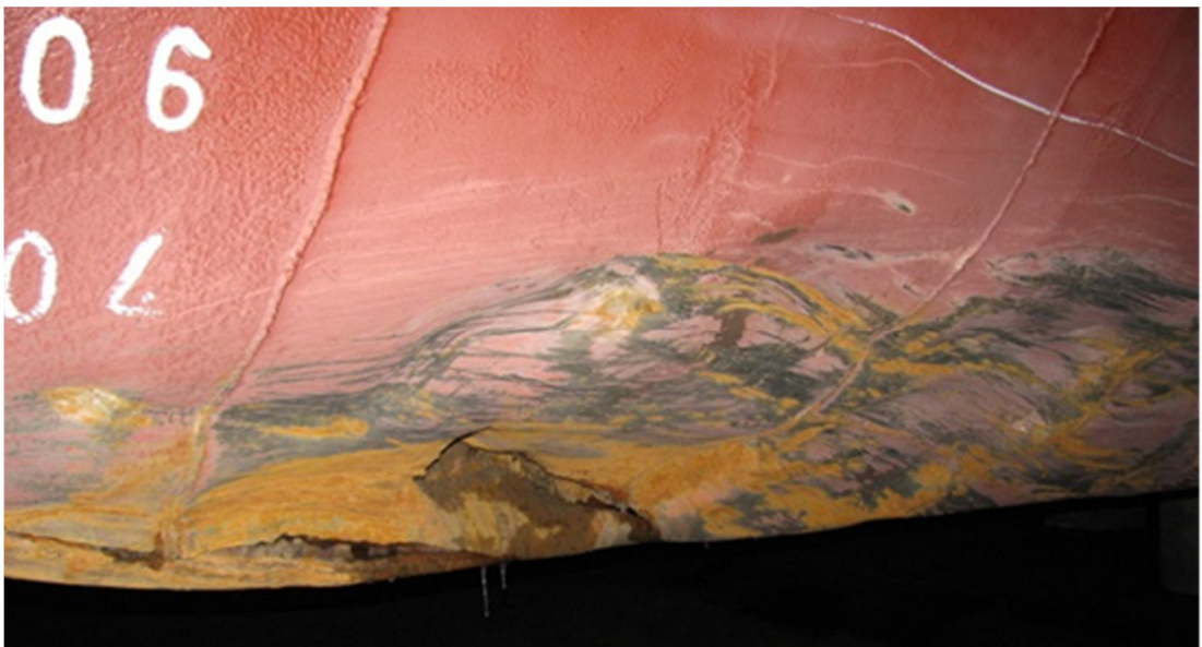
Bild 9. Dockningsfoto. Reva i fartygets botten på babordssidan av fören. (Foto: Olycksutredningscentralen)
