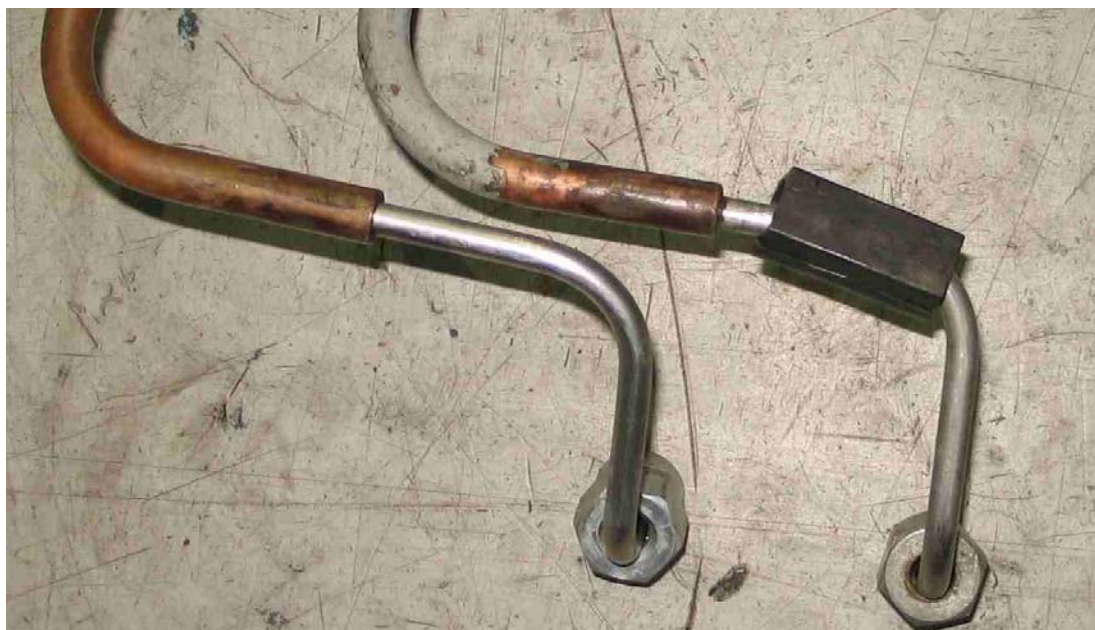
Bild 16. De bränsleinsprutningsrör som leder till huvudmaskinens cylindrar. Rörens dubbelstruktur kan tydligt ses. Foderröret, som är av koppar, når inte ut till ändan av insprutningsrören. I bild 17a pekar man på läckagestället. Rören hade rengjorts och fotograferades på maskinreparatörens verkstad.
