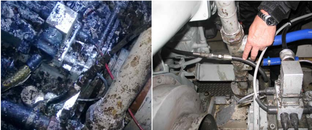
Bild 13b. Det rör som ledde till mätaren för oljetrycket i huvudmaskinens reduktionsväxel var sönder efter branden. Foto till vänster 28.1 (Rauma Survey) och foto till höger 31.5.2013.
