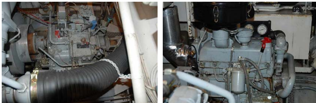
Bild 4b. Till vänster huvudmaskinens reduktionsväxel och den andra insugslangen som går till brassen på SB-sida. Efter branden ersattes de bägge slangarna med ett filter. Till höger hjälpmaskinen. Bilderna är från fartygets auktionspresentation på Internet, hösten 2009.
