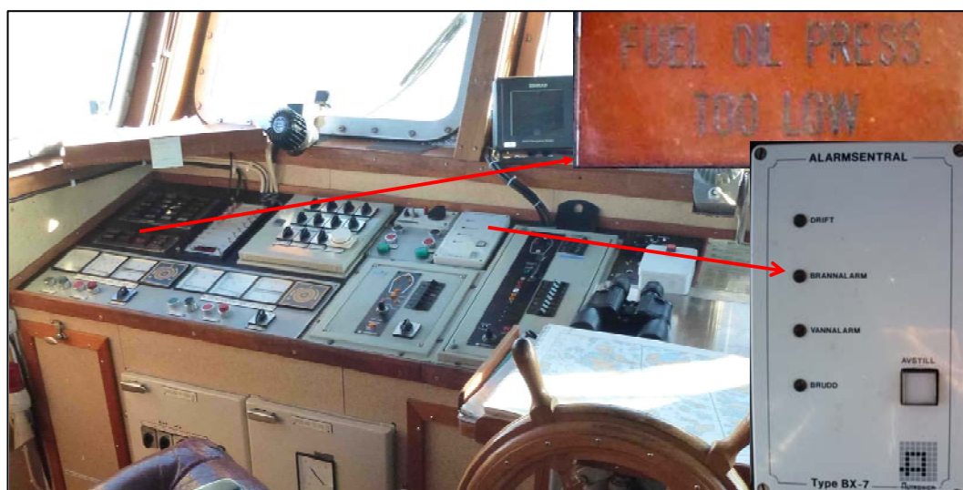
Bild 3a. Styrhyttens babords (BB) sida. Pilen till vänster visar larmet för lågt drivmedelstryck och pilen till höger placeringen av brandlarmet.
