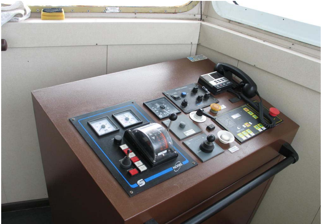
Kuva 5. Ohjaamon oikean puolen siipipulpetti ohjauspaneelieineen. Päällikkö ohjaili alusta tästä luotsin poistuessa aluksesta. Vasemmalla puolella on identtinen pulpetti.
