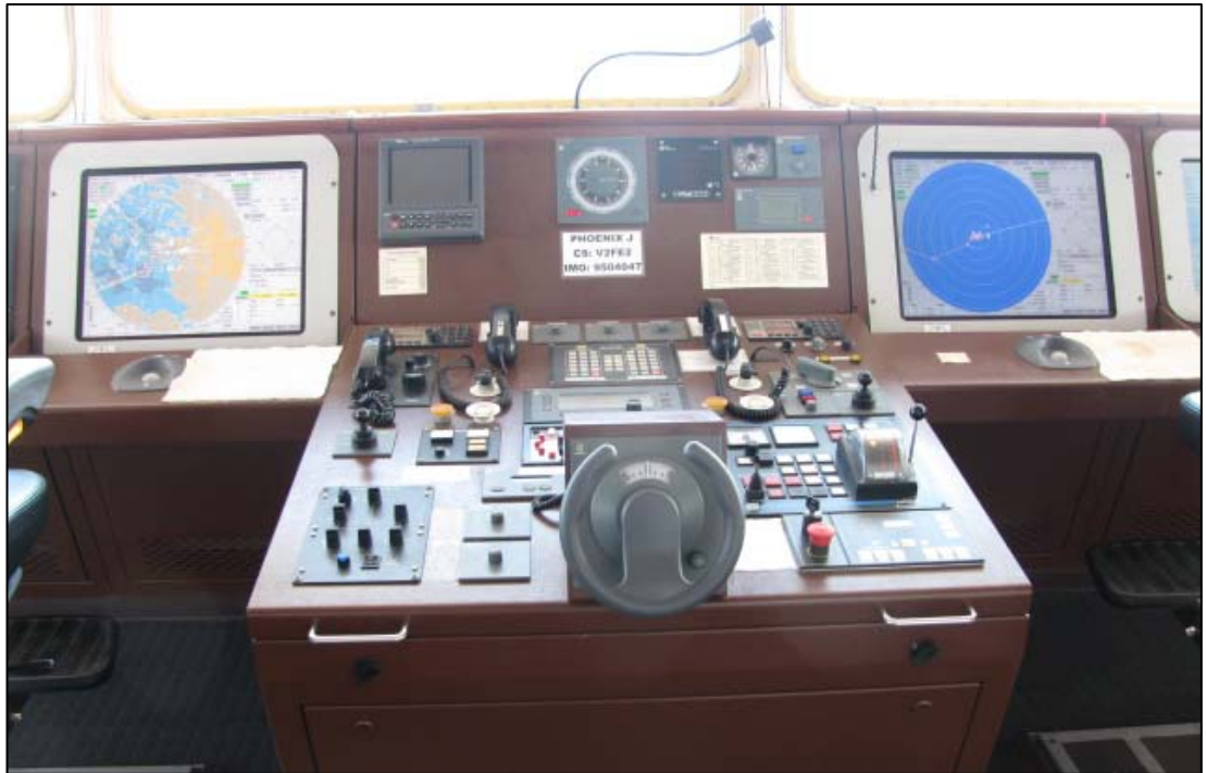
Kuva 4a. Ohjaamon keskipulpetti ja käsiruori ohjauspylväässä. Päälikkö ohjaili alusta tästä karilleajohetkellä.
