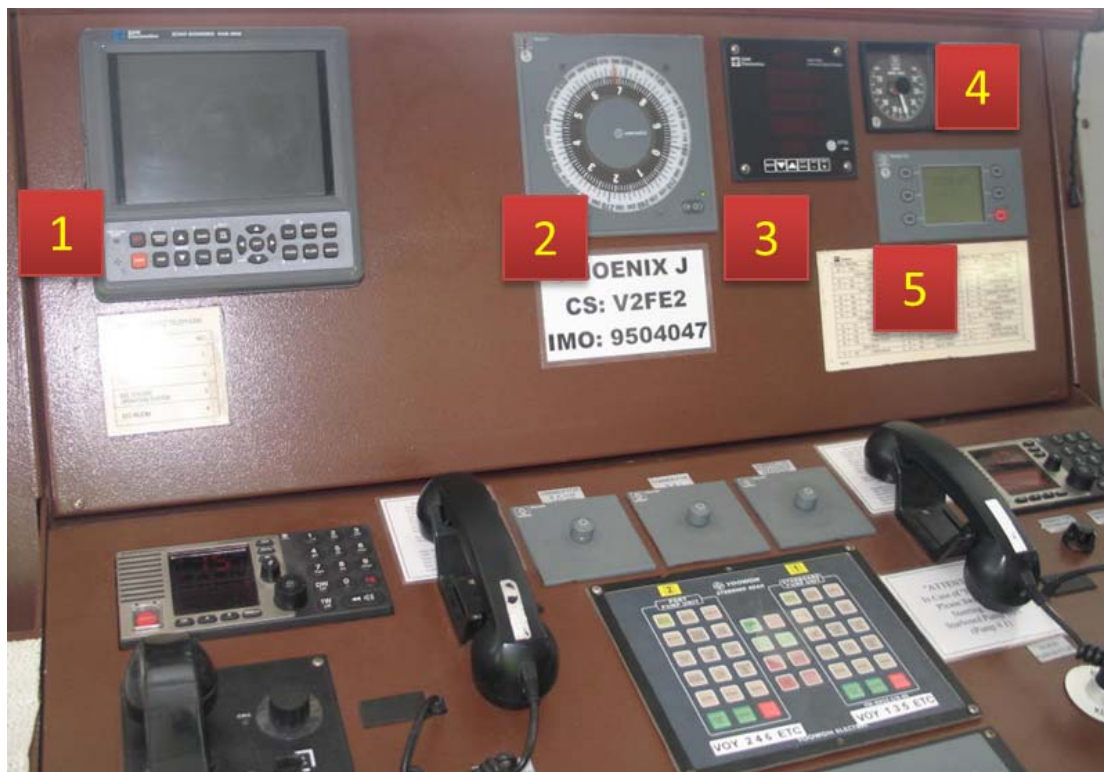
Kuva 4b. Sensorinäytöt keskipulpetissa. 1 = kailuluotain, 2 = hyrräkompassi, 3 = nopeusloki, 4 = ruorikulmaindikaattori, 5 = monitoiminäyttö.
