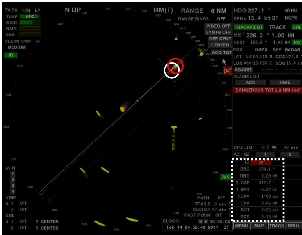
Bild 6. Kl. 3.59.43. BIRKA TRANSPORTERs hastighet börjar avta. Vit cirkel WILLEMPJE HOEKSTRA, röd cirkel BIRKA TRANSPORTER, vit streckad rektangel ARPA-data. Tid till kollisionen cirka 1 minut. CPA 0,06 nm, TCPA 1,03 min.
