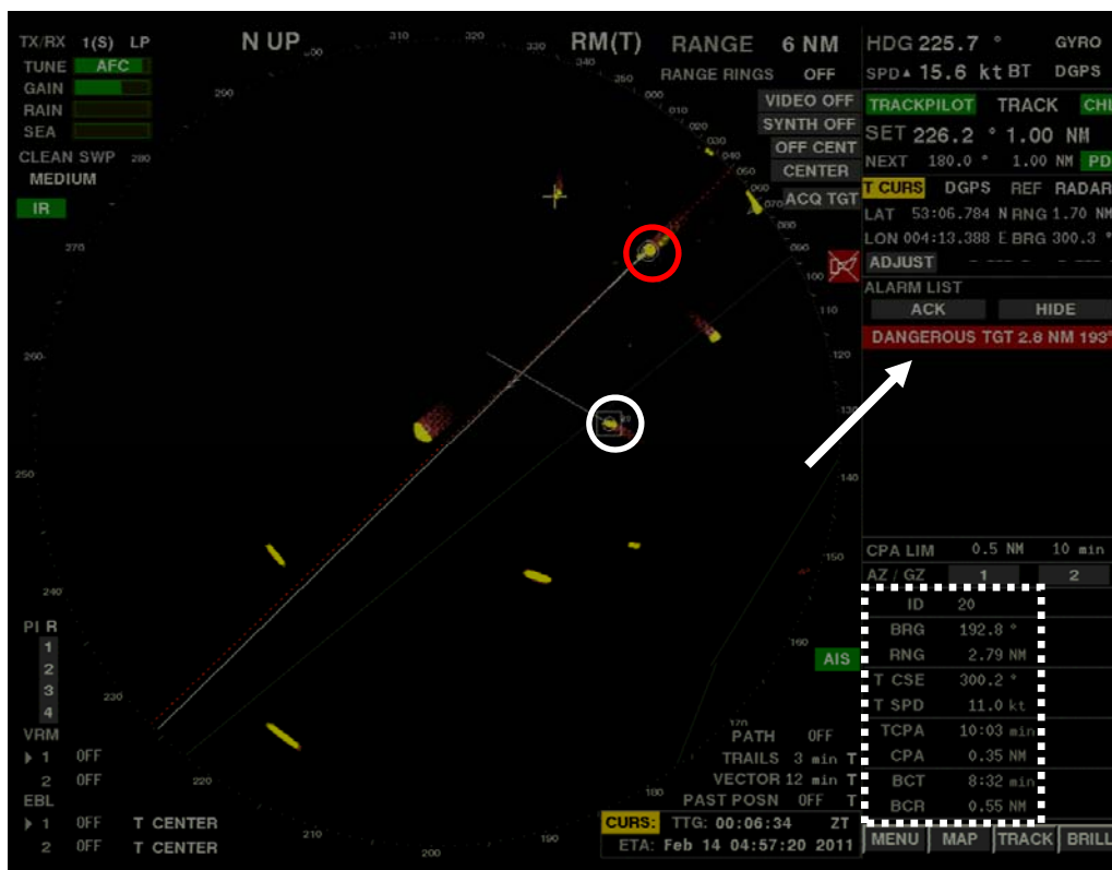
Bild 5. Kl. 3.50.47. Larmet för farligt mål aktiveras på BIRKA TRANSPORTERs radar (vit pil). Målgränserna var inställda på CPA 0,5 nm och TCPA 10 min. CPA 0,35 nm och TCPA 10,03 minuter. Tid till kollisionen cirka 10 minuter. Den vita streckade rektangeln visar WILLEMPJE HOEKSTRAs ARPA-data.
