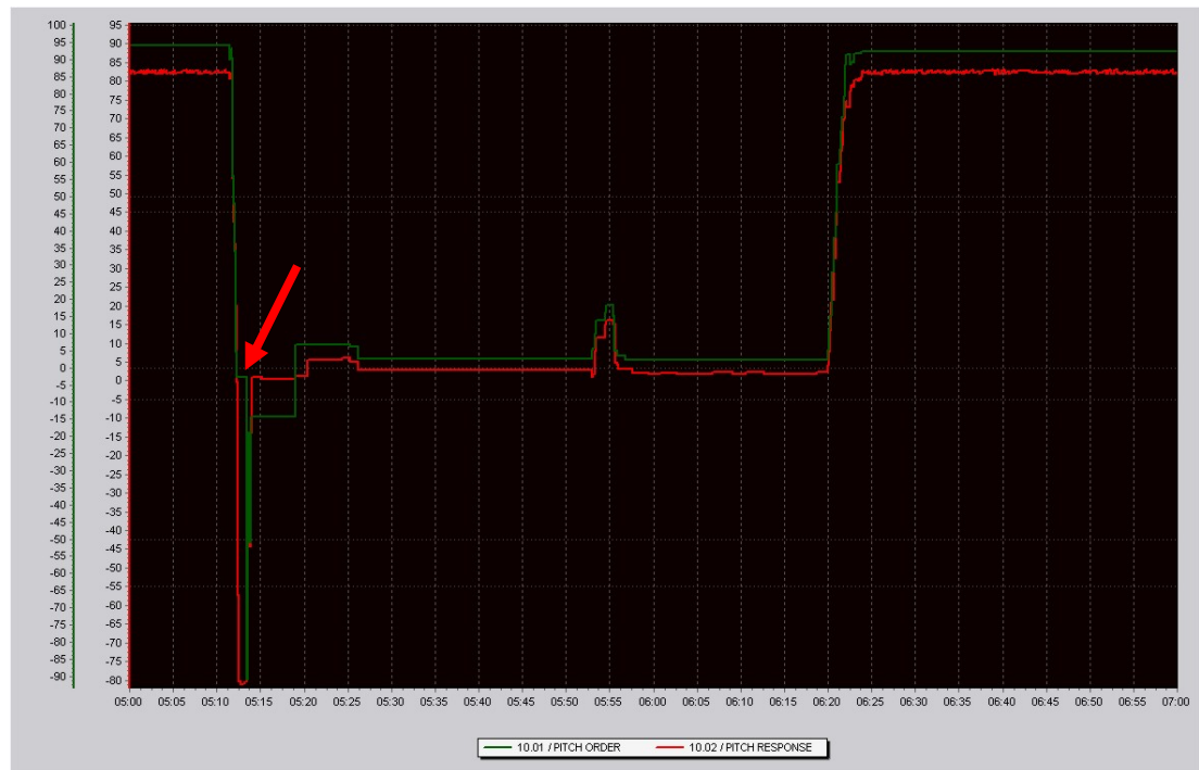
Bild 8. Propellerloggen från BIRKA TRANSPORTER. Stigningsgraden i grönt och stigningsresponsen i rött. Tiden är cirka 12 minuter före S-VDR-tiden.
