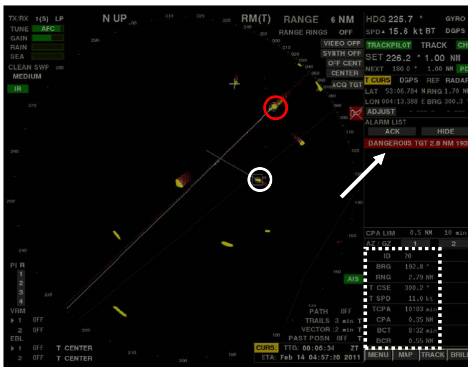
Bild 8. Kl. 3.50.50. Cirka 10 min innan kollisionen. Larmet för farligt mål aktiverades (vit pil). CPA 0,35 nm och TCPA 10,03 min.
