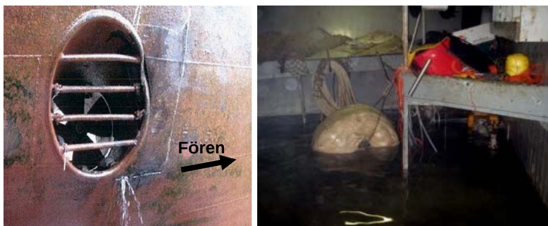
Bild 11. Vänster: skador på styrbord sida på WILLEMPJE HOEKSTRA, i bogpropellertunneln på WILLEMPJE HOEKSTRA.
