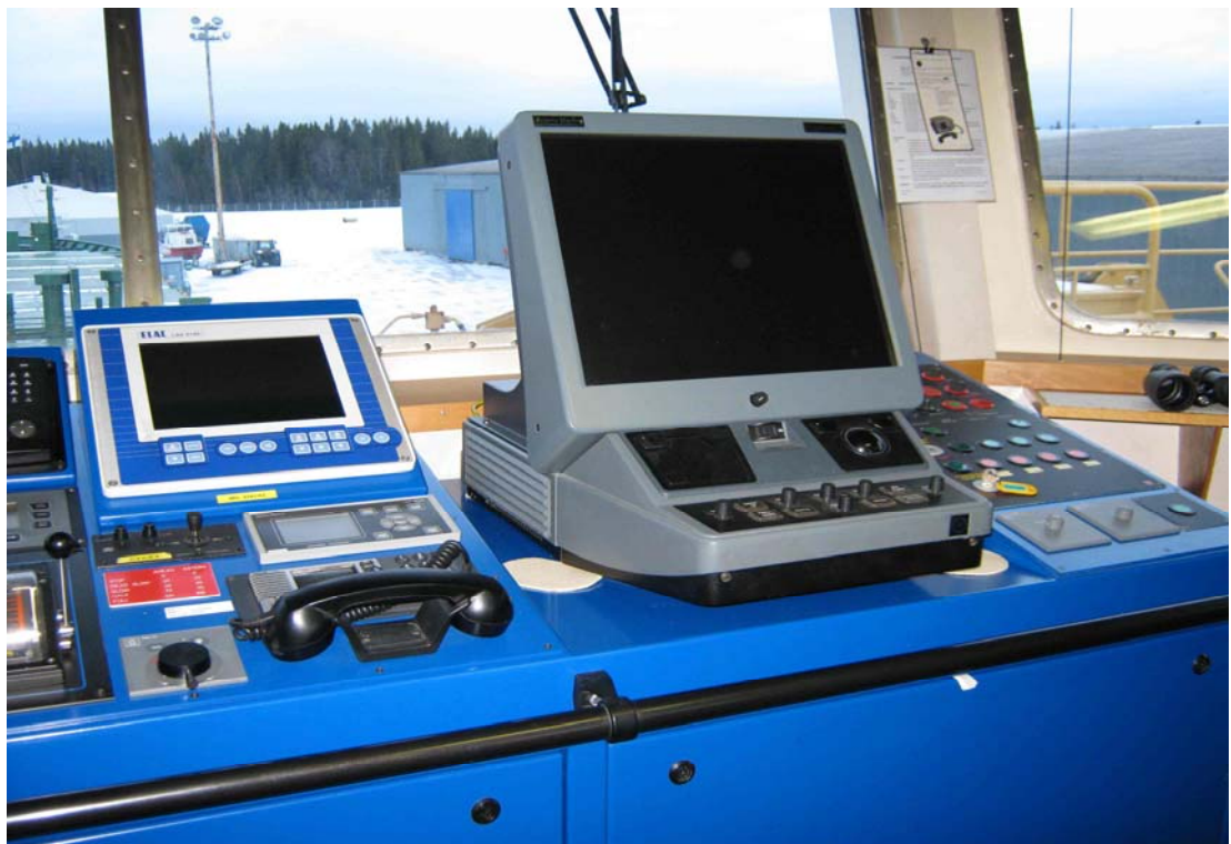
Bild 4. Styrpulpeten; styrbords radarskärm.
