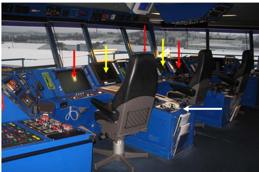
Bild 2. Utblick över kommandobryggan, fartygets manöverplatser. Fotograferat i Åbo den 24 november 2009. De röda pilarna visar radarskärmarna (en skärm finns bakom stolen) och de gula pilarna conning-displayerna. Linjelotsen sitter i mitten (huvudstyrningsplats), vaktchefen sitter till höger (monitorerande navigerare) och befälhavarens stol finns till vänster. Den vita pilen pekar på styrkonsolen för styrmaskinens tryckackumulatorer; reglerspakarna till höger och till vänster.
