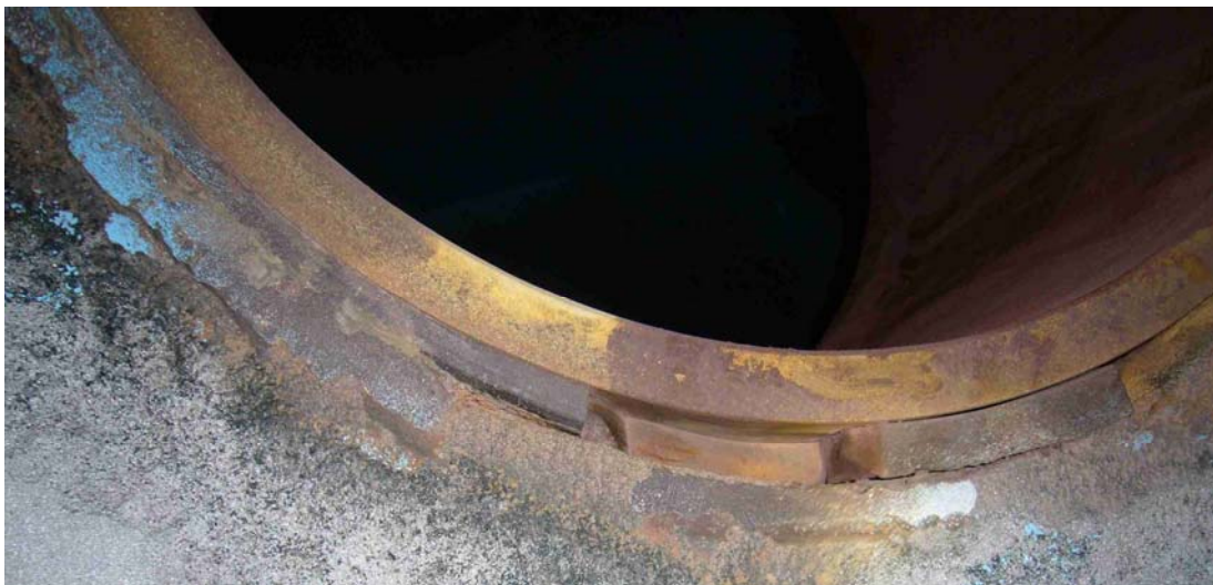
Bild 24. Epoxi som delvis har lossnat från BB-rodertappslagret. De tunna sprickorna mellan å ena sidan epoxin och lagerhuset, å andra sidan mellan epoxin och bronsbussningen syns i bilden. Fotografiet taget den 3 december 2009.
