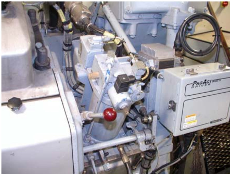
Kuva 6. Pro Act Driver'in kotelo kuvan oikeassa reunassa. Kotelo on pääkoneen keulapäässä oikealla puolella.
