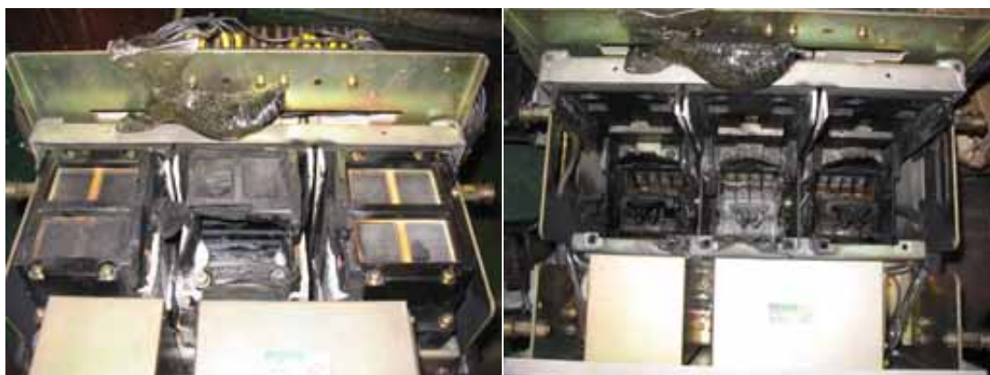
Bilder 3 och 4. Kåpan till den brunna strömbrytaren i mitten.
