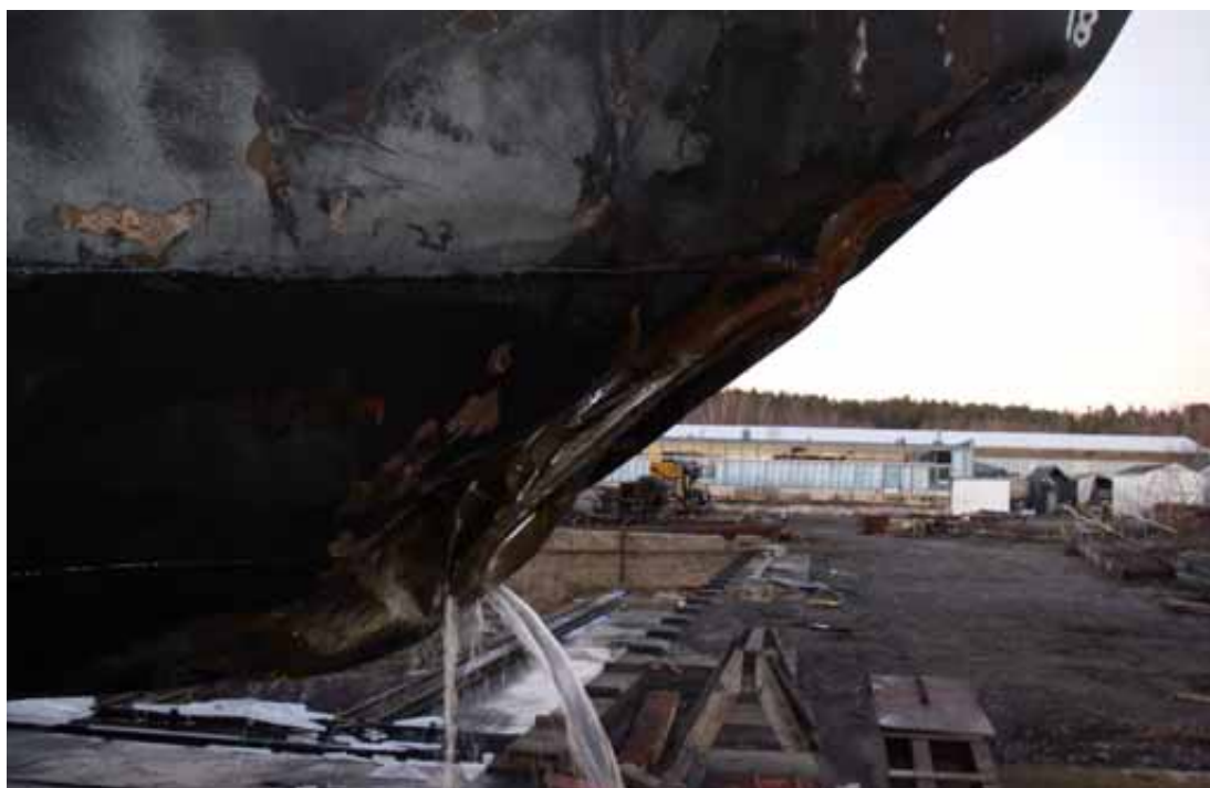
Kuva 5. Keulan vauriot. (Kuva MKL)
